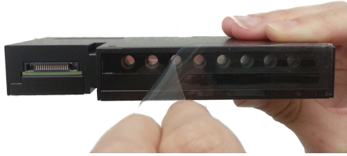
Abbildung 9 Entfernen der Kunststofffolie vom optischen Modul
