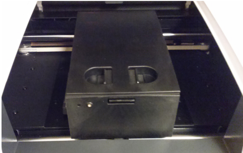
Abbildung 5 Gehäuseträger des optischen Moduls, mittig in der Türöffnung des Geräts
