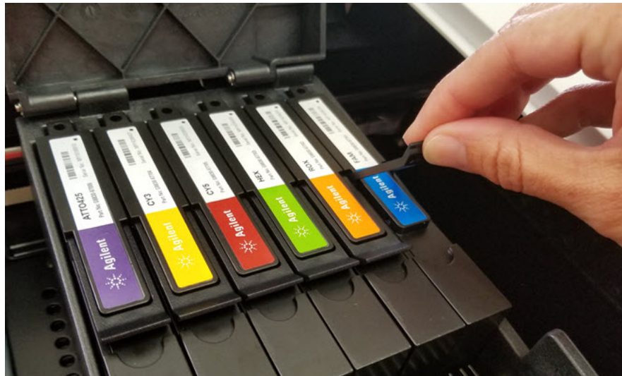
Abbildung 47 Anheben der Lasche an einem optischen Modul
