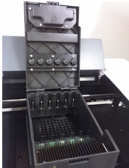
Abbildung 7 Steckplätze für die optischen Module
