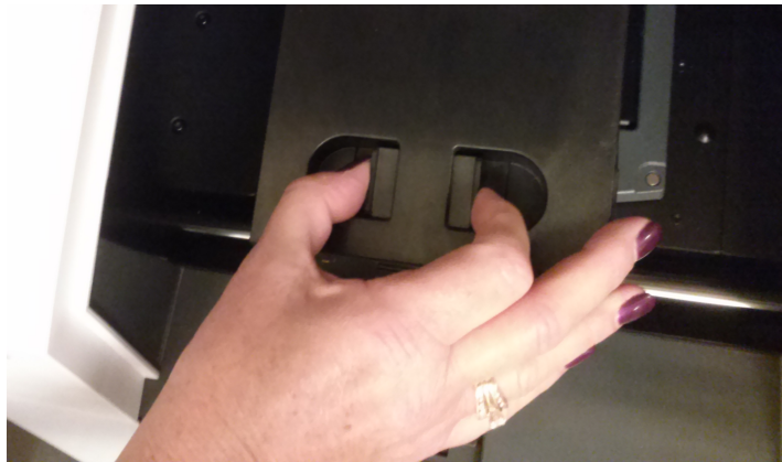
Abbildung 6 Öffnen des optischen Modulgehäuses
