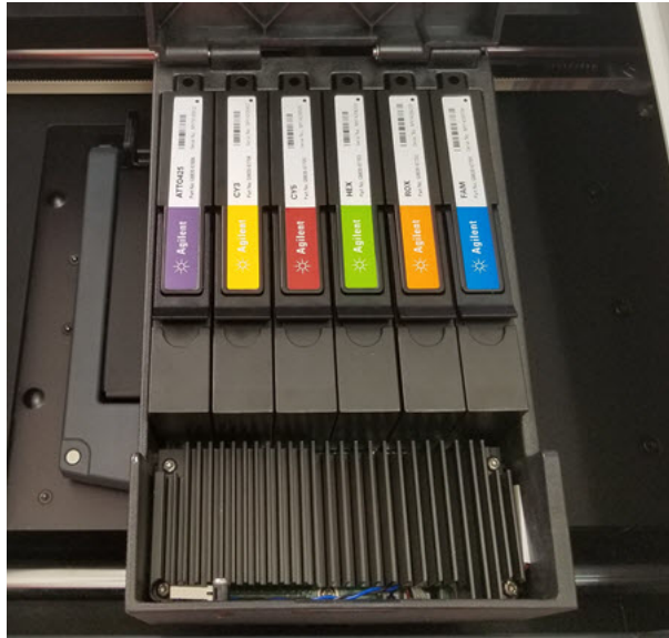
Abbildung 10 Installierte optische Module
