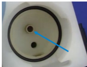
Figure 46. Dépassement du venturi de la face arrière du bloc nébuliseur
