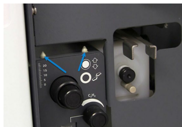
Figure 12. Panneau avant du compartiment de l'échantillon au-dessus des deux tenons en haut du dispositif de réglage du brûleur.
