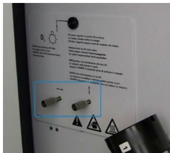
Figure 30. Boutons de réglage de la lampe D 2
