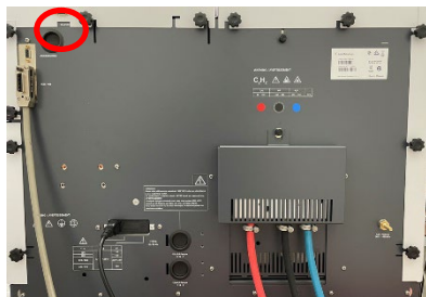
Figure 40. Prise RS-232 à 9 broches située à l'arrière de l'instrument
