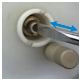
Figure 51. Vérification du caractère fonctionnel du ressort
