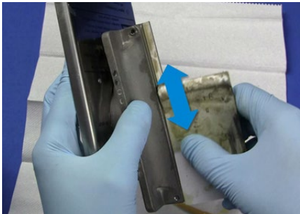
Figure 83. Lustrage de la surface externe de la fente du brûleur
