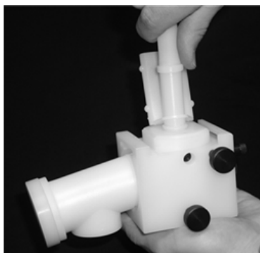
Figure 70. Vissage du tube d'évacuation dans le bloc nébuliseur
