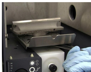
Figure 79. Serrage de la poignée de rotation pour faire tourner le brûleur
