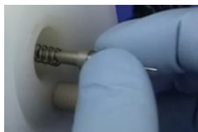
Figure 48. Insertion de l'ensemble capillaire et du ressort dans le guide pour capillaire.
