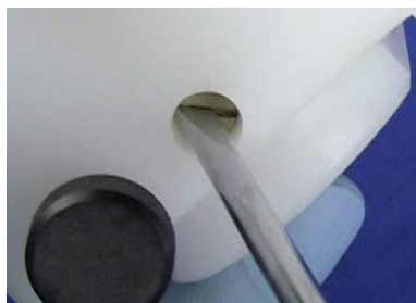
Figure 62. Serrage de la vis de serrage – côté du nébuliseur
