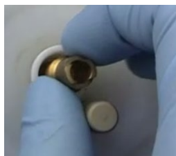
Figure 50. Insertion du collier de serrage dans le bloc nébuliseur.
