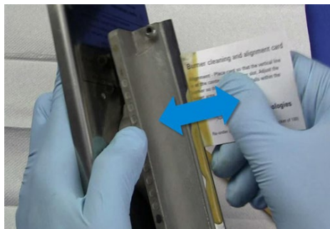
Figure 82. Glissement de la carte de nettoyage du brûleur en va-et-vient dans et hors de la fente
