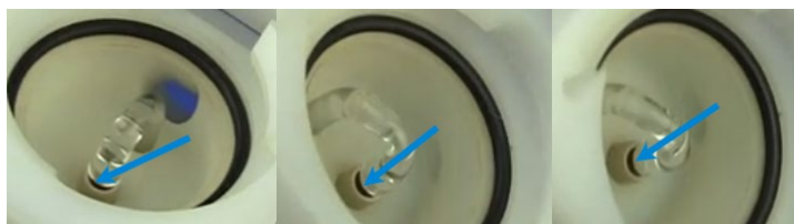
Figure 66. Espace homogène d'environ 0,5 mm entre la bille d'impact et la paroi interne du venturi
