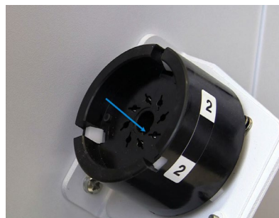
Figure 85. Douille de lampe avec indication de l'encoche
