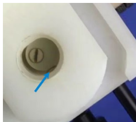
Figure 63. Vis de serrage en contact avec le bloc d'ajustement de la bille d'impact
