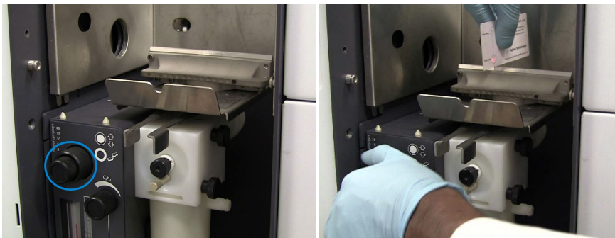
Figure 34. Boutons de réglage du brûleur (à gauche). Rotation du bouton (à droite).
