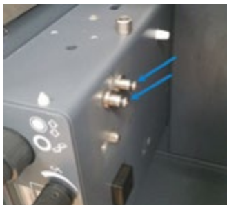
Figure 74. Embouts de sortie du combustible et de l'oxydant
