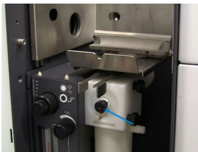
Figure 37. Emplacement de la molette. L'anneau de verrouillage se trouve entre la molette et le bloc nébuliseur.
