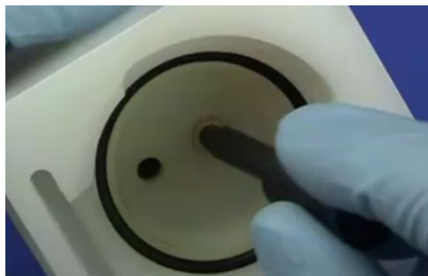
Figure 43. Insertion de l'outil d'extraction du venturi dans le venturi
