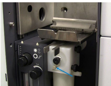
Figure 36. Vis d'ajustement de la bille d'impact
