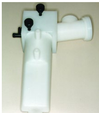
Figure 73. Ensemble nébuliseur-chambre de nébulisation complet
