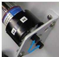
Figure 28. Boutons de réglage de la lampe
