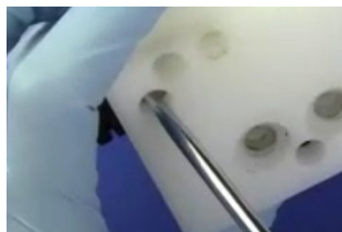
Figure 61. Serrage de la vis d'immobilisation – côté admission de gaz du nébuliseur
