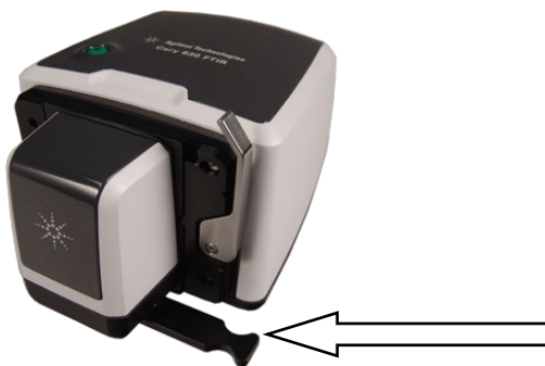
Figure 18 Accessoire de Réflectance Diffuse fixé au FTIR Cary 630. Le support d'échantillon pousse sur la fente en bas à droite de l'accessoire.
