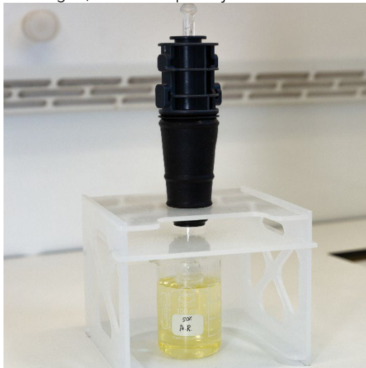
Figura 15A. Mergulhe a tocha na solução de água régia. Verifique se o injetor está imerso na solução.
