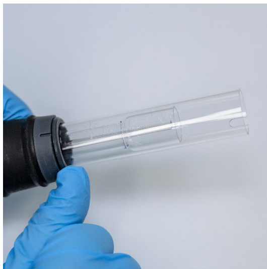
Figura 9. Remoção do vedante superior de uma tocha semidesmontável pressionando-o com uma unha de polegar
