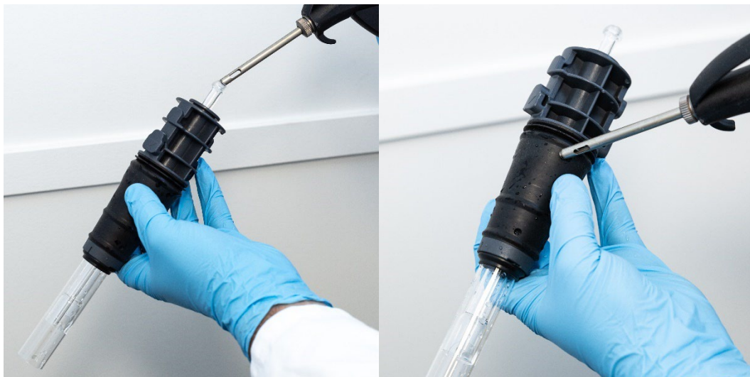
Figura 18A e B. Use ar comprimido, argônio ou nitrogênio para secar a tocha.
