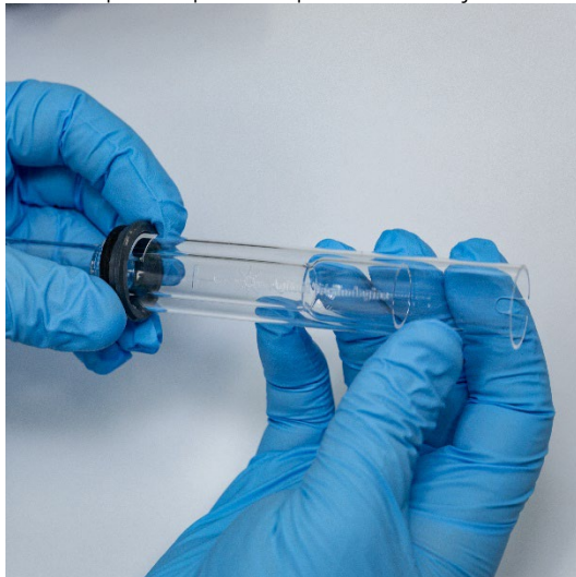
Figura 4. O vedante superior sendo recolocado no conjunto de tubos externos de quartzo
