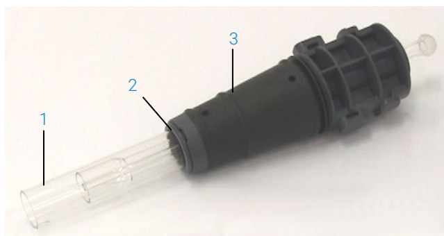
Figura 3. Tocha desmontável, onde: 1. Tocha, 2. Vedante superior e 3. Corpo da tocha
