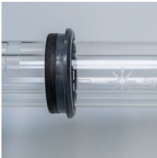
Figura 5. O vedante superior alinhado com a marca de alinhamento no tubo externo de quartzo
