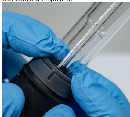
Figura 8. Certifique-se de que o vedante esteja encaixado corretamente pressionando firmemente as bordas superiores
