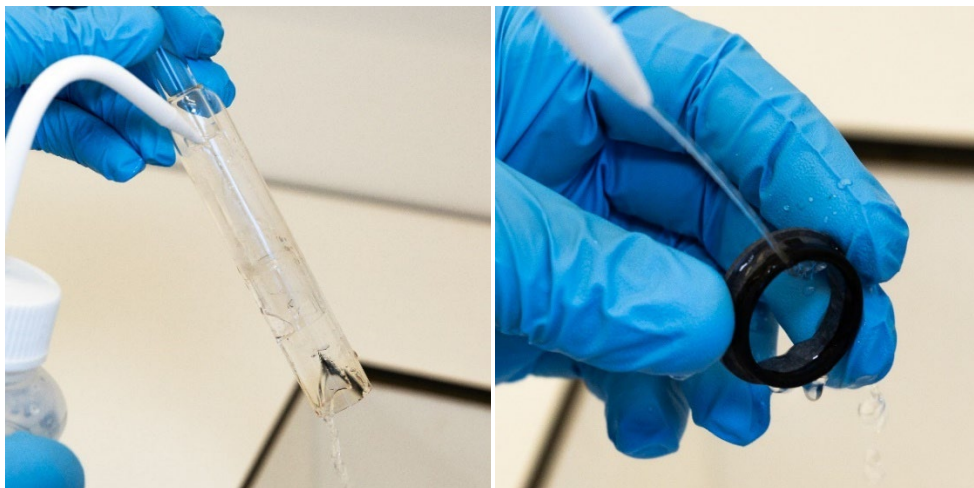
Figura 17A e B. Lave o conjunto de tubos externos de quartzo e o vedante superior com água deionizada.
