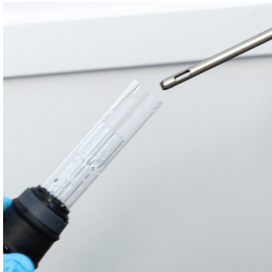
Figura 19. Sopre ar comprimido, argônio ou nitrogênio limpo na extremidade aberta do conjunto de tubos.
