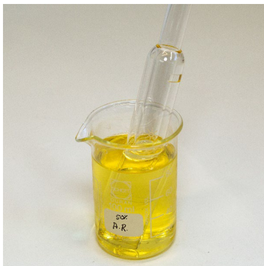
Figura 15D. Imersão do conjunto de tubos externos de quartzo em água régia.
