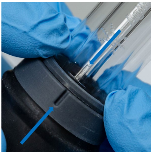
Figura 7. A marca de alinhamento no conjunto de tubos externos de quartzo deve estar alinhada com a canaleta no corpo da tocha
