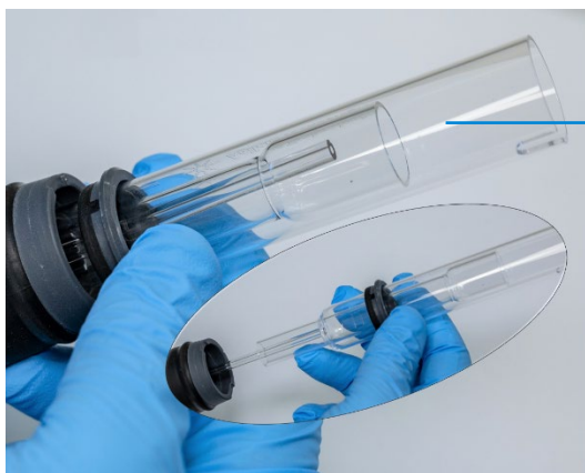
Figura 11. Remoção do conjunto de tubos de quartzo do corpo da tocha
