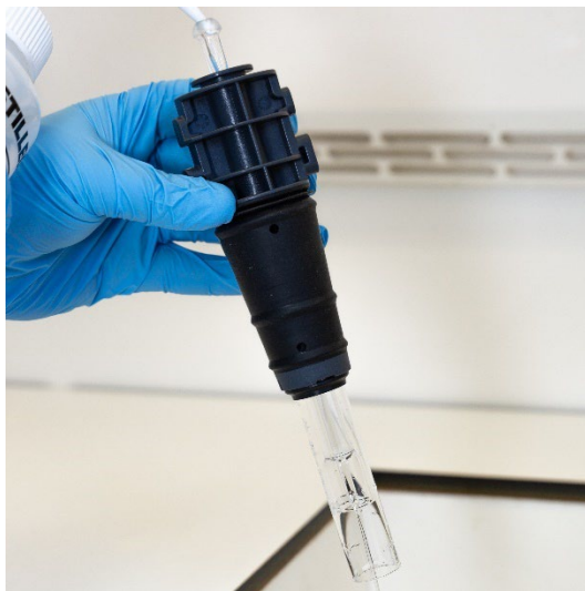
Figura 16A. Enxágue o injetor com água deionizada através do conector da junta esférica.
