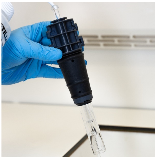
Рис. 16А. Промывка устройства для ввода пробы струей деионизированной воды, пропускаемой через шарнирное соединение
