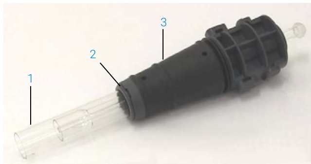
Рис. 3. Разборная горелка с обозначением следующих частей. 1. Горелка. 2. Герметизирующее кольцо на горелке. 3. Корпус горелки
