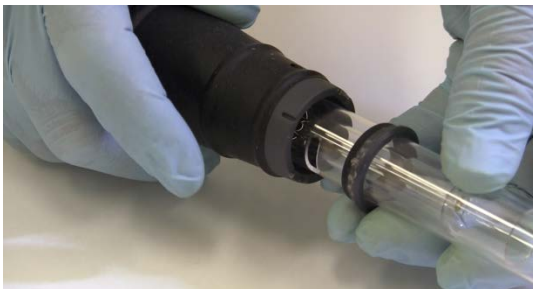
Рис. 6. Горелка, вставленная в корпус
