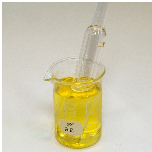
Рис. 15D. Отмачивание наружных кварцевых трубок в растворе смеси азотной и соляной кислот
