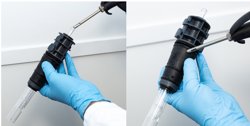
Рис. 18А и В. Использование сжатого воздуха, аргона или азота для высушивания горелки
