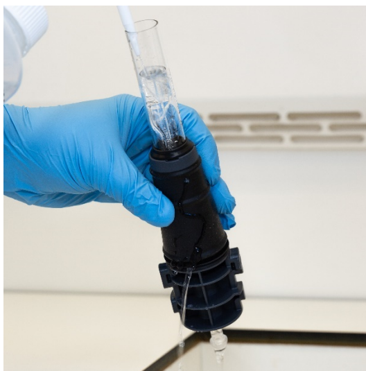
Рис. 16В. Промойте отверстия для газа и шарнирное соединение деионизированной водой
