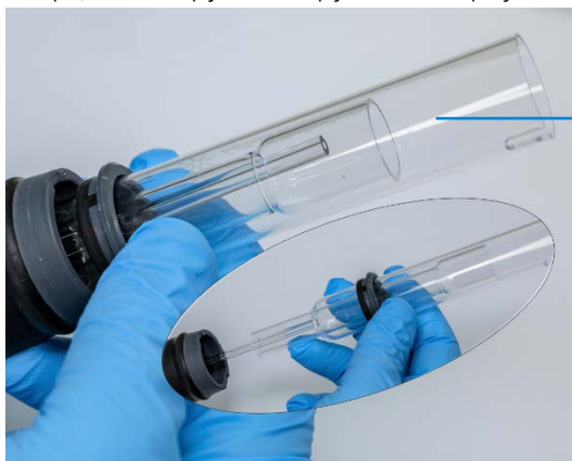
Рис. 11. Удаление кварцевых трубок из корпуса горелки
