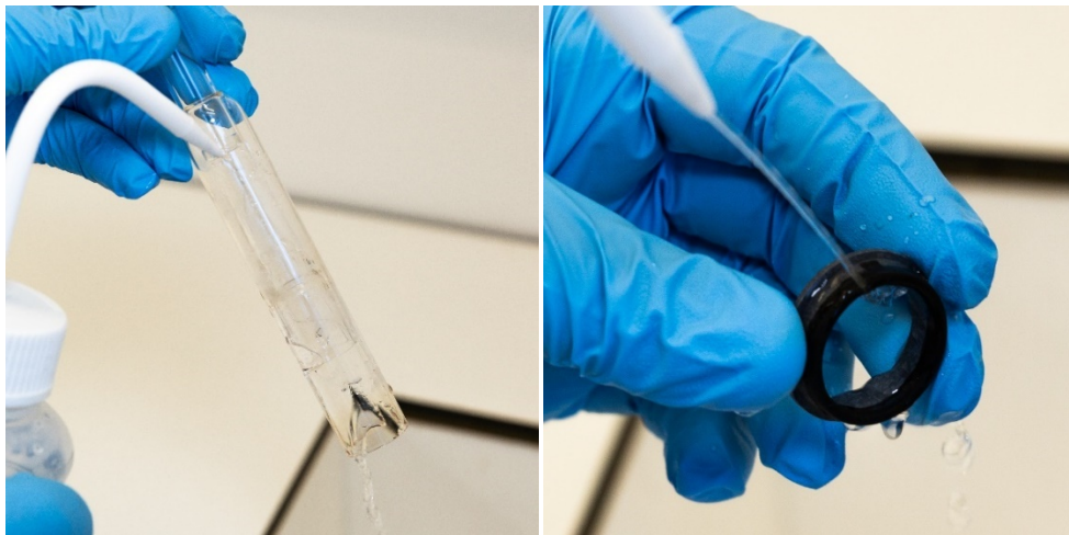
Рис. 17А и В. Промывка наружных кварцевых трубок и верхнего уплотнения деионизированной водой
