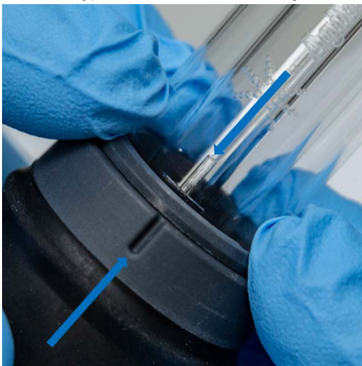
Рис. 7. Отметка выравнивания на узле наружной кварцевой трубки должна быть совмещена с прорезью на корпусе горелки
