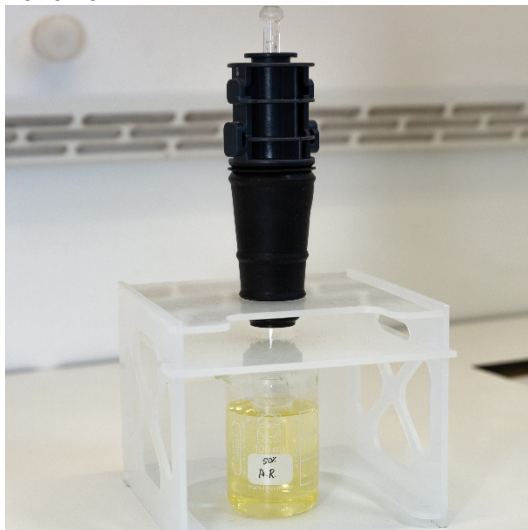
Рис. 15А. Отмачивание горелки в растворе смеси азотной и соляной кислот. Устройство для ввода пробы должно быть погружено в раствор
