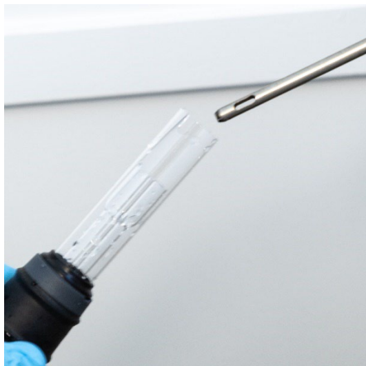
图 19. 将干净的压缩空气、氩气或氮气通过管组的开口端吹入。
