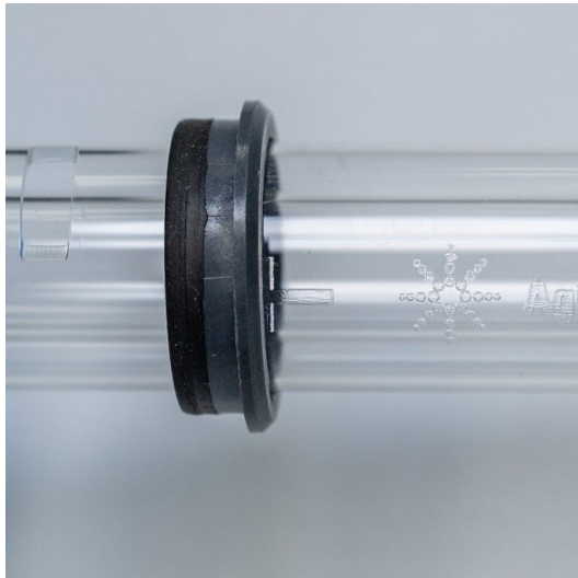
图 5.顶部密封垫与石英外管上的对准标记对齐
