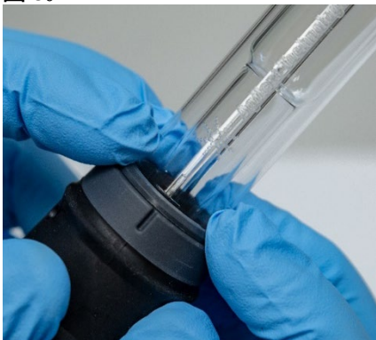
图 8.用力按顶部边缘，确保密封垫正确固定
