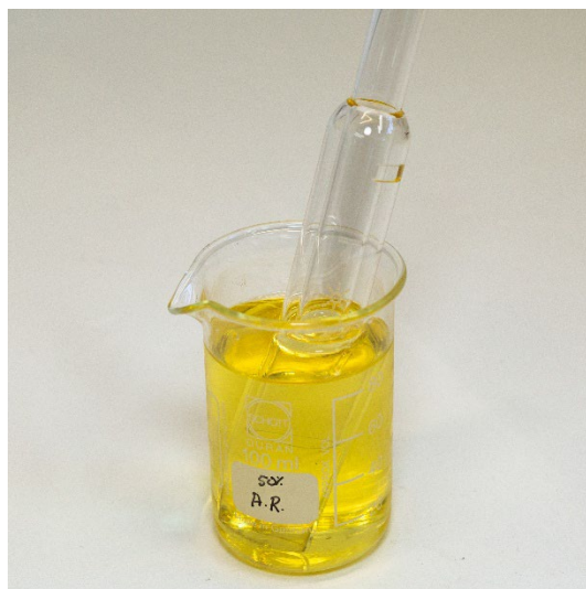
图 15D. 浸泡在王水中的石英外管组。
