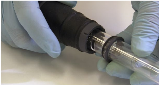
图 6. 炬管插入炬管体中
