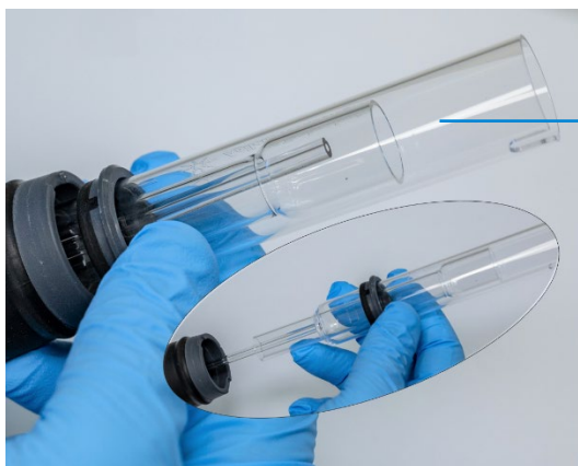
图 11. 从炬管体上卸下石英管组
