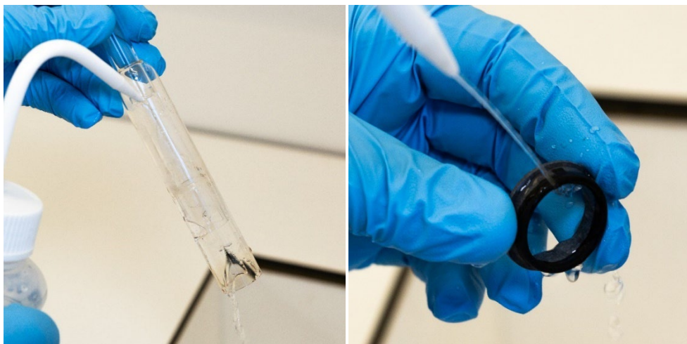
图 17A 和 B. 用去离子水冲洗石英外管组和顶部密封垫。
