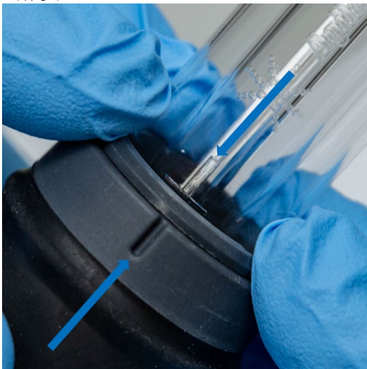
图 7. 石英外管组上的对准标记应与炬管体上的凹槽对准
