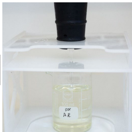
図 15B および C. 組み立て済みトーチクリーニングスタンドと交換可能なトーチプレートと、王水に浸漬したインジェクタ。
