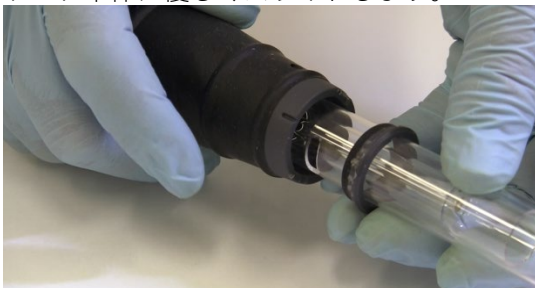
図 6. トーチ本体へのトーチの取り付け
