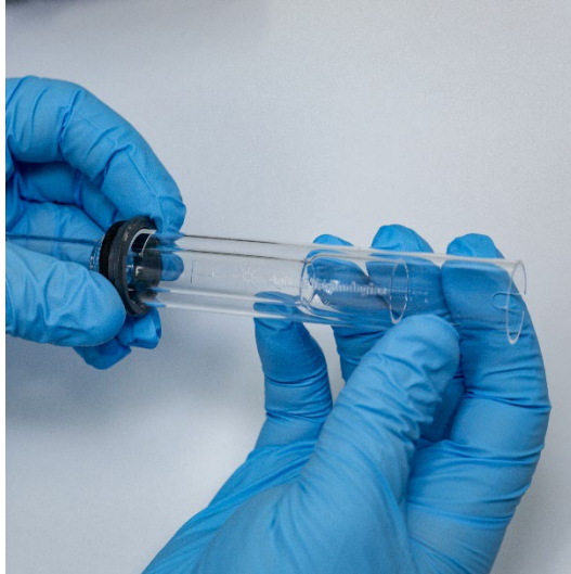
図 4.石英製外側チューブセットに再装着された上部シール
