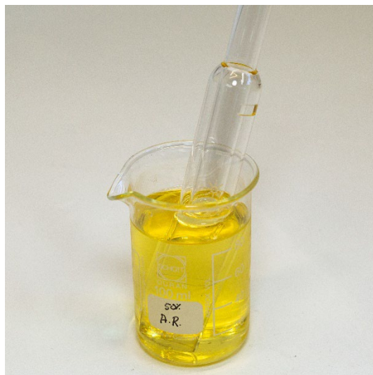
図 15D. 王水に浸漬している石英製外側チューブセット
