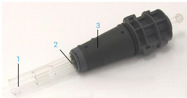
図 3. デマウントブルトーチ: 1. トーチ、2. 上部シール、3. トーチ本体
