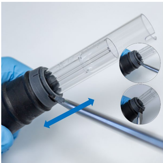
図 10.幅広のマイナスドライバを使用して上部シールを外す
