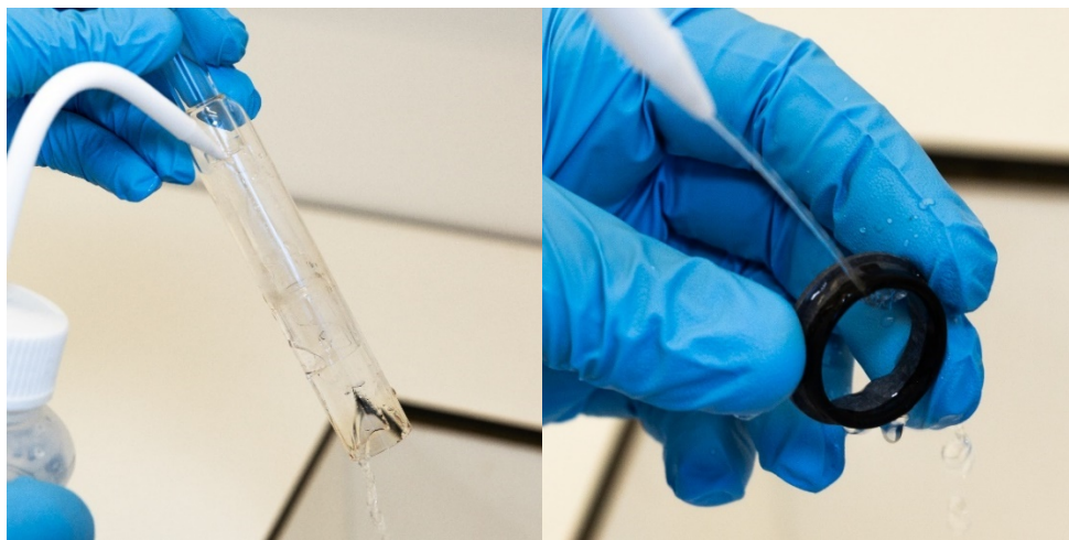
図 17A および B. 石英製外側チューブセットと上部シールを脱イオン水で洗浄します。
