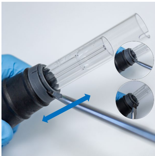
図 10. 幅広の刃のマイナスドライバを使用して上部シールを外します。
