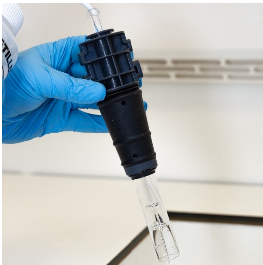
図 16A. ボールジョイントコネクタからの脱イオン水でインジェクタを洗浄します。
