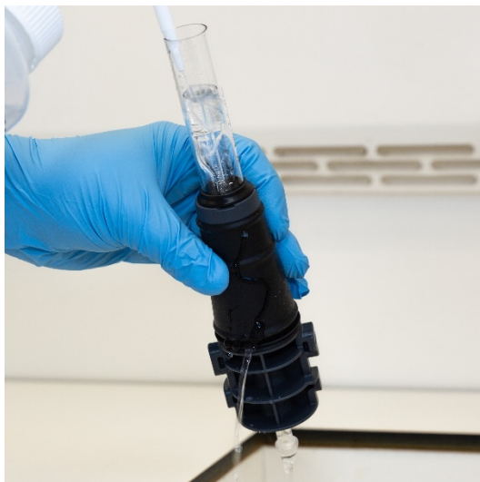
図 16B. ガスポートおよびボールジョイントコネクタインジェクタに脱イオン水をかけて流します。
