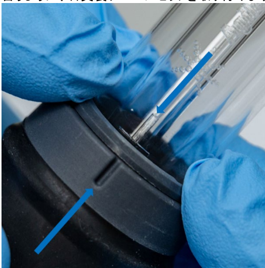
図 7. 石英製外側チューブセットの合わせマークをトーチ本体の溝と合わせるようにすることが必要です。
