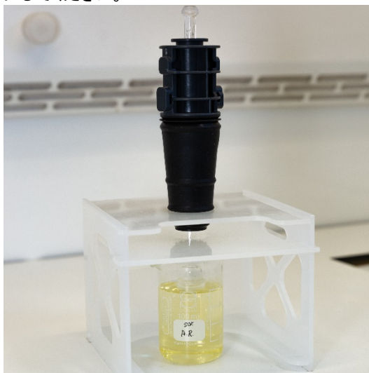
図 15A. 王水溶液にトーチを浸します。確実にインジェクタが溶液に浸漬されていることを確認します。
