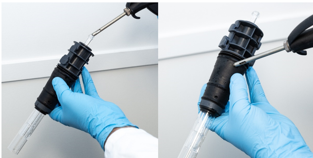
図 18A および B. 圧縮空気またはアルゴンまたは窒素を使用してトーチを乾燥させます
