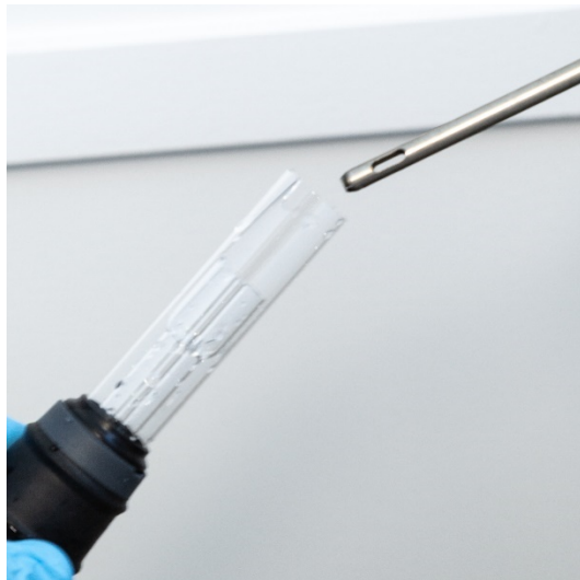
図 19. チューブセットの開口端から、きれいな圧縮空気またはアルゴンまたは窒素を吹き込みます
