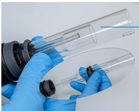
図 11. トーチ本体からの石英製チューブセットの取り外し
