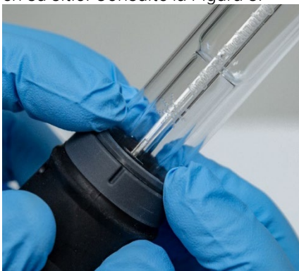
Figura 8. Presione firmemente los bordes superiores para garantizar que el sello quede bien encajado.
