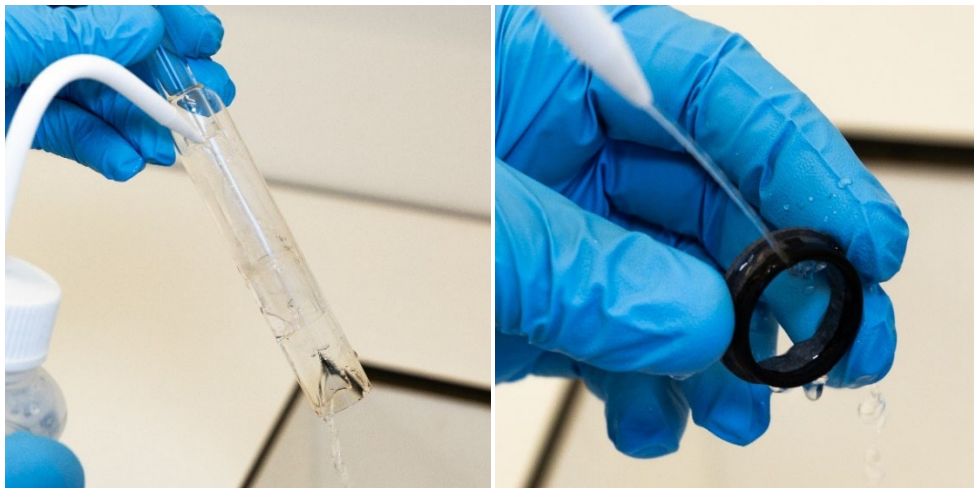
Figura 17A y B. Lavado del conjunto del tubo exterior de cuarzo y el sello superior con agua desionizada.
