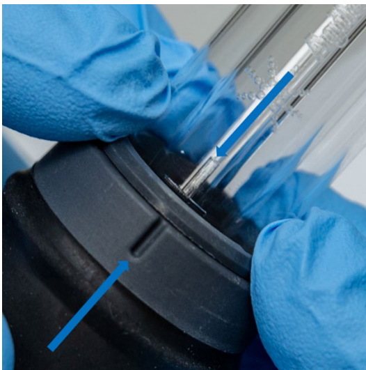
Figura 7. La marca de alineación del conjunto del tubo exterior de cuarzo debe quedar alineada con el surco del cuerpo de la antorcha.
