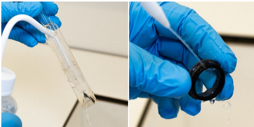
Figure 17A et B. Rincez l'ensemble de tubes en quartz externes et la bague supérieure avec de l'eau déionisée.
