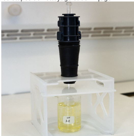
Figure 15A. Trempez la torche dans la solution d'eau régale. Assurez-vous que l'injecteur est immergé dans la solution.
