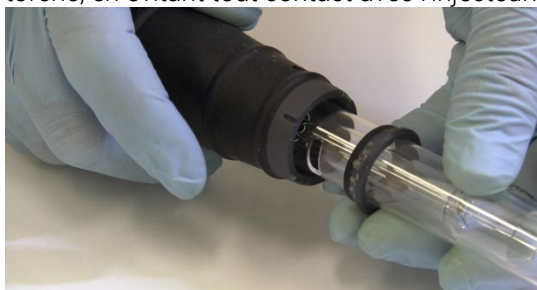
Figure 6. Torche insérée dans le corps de la torche
