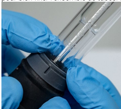
Figure 8. Assurez-vous que la bague est bien en place en appuyant fermement sur ses bords supérieurs
