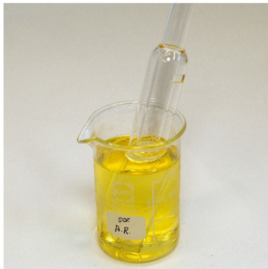
Figure 15D. Ensemble de tubes en quartz externes immergé dans l'eau régale.
