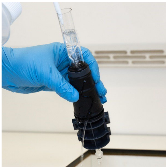
Figure 16B. Rincez les ports de gaz et le raccord hémisphérique avec de l'eau déionisée.
