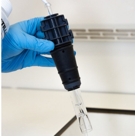
Abbildung 16A. Spülen des Injektors mit deionisiertem Wasser durch die Kugelgelenkverbindung.
