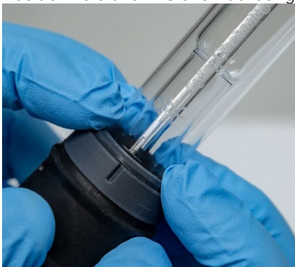
Abbildung 8. Stellen Sie sicher, dass die Dichtung richtig sitzt, indem Sie fest auf die obere Kante drücken
