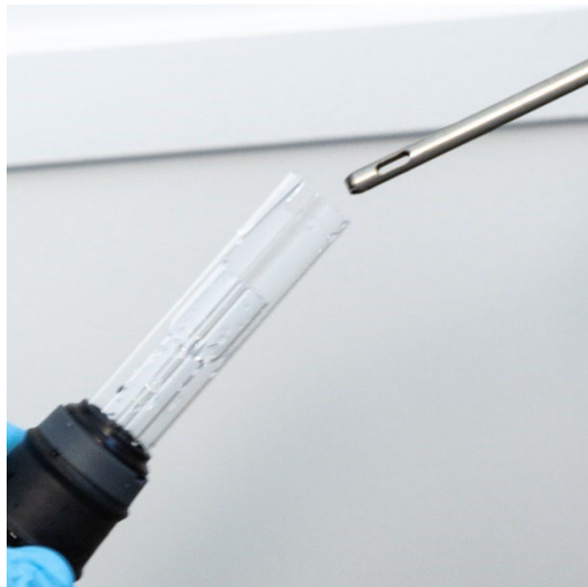
Abbildung 19. Blasen Sie Druckluft, Argon oder Stickstoff durch das offene Ende des Außenrohrsets.
