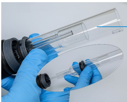
Abbildung 11. Entfernen des Quarzrohrsets aus dem Fackelkörper
