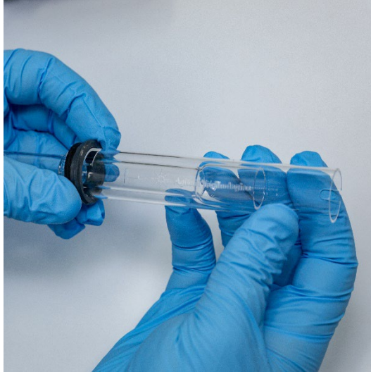
Abbildung 4. Die obere Dichtung wird auf das Quarz-Außenrohrset geschoben
