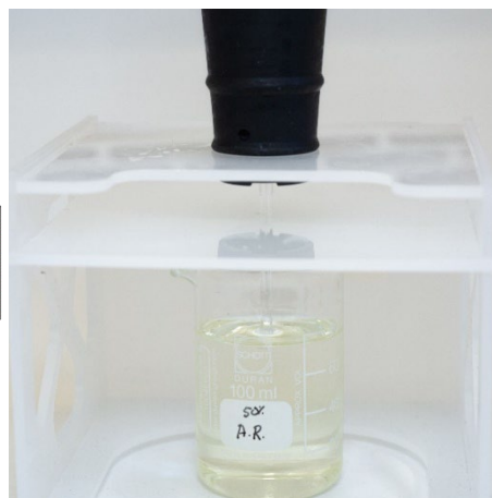
Abbildung 15B und C. Montierter Fackel-Reinigungsständer mit austauschbaren Schutzplatten. Injektor taucht in Königswasser ein.
