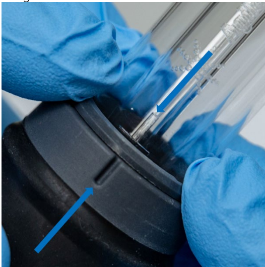
Abbildung 7. Die Markierung auf dem Quarz-Außenrohrset muss auf die Einkerbung am Fackelkörper ausgerichtet sein
