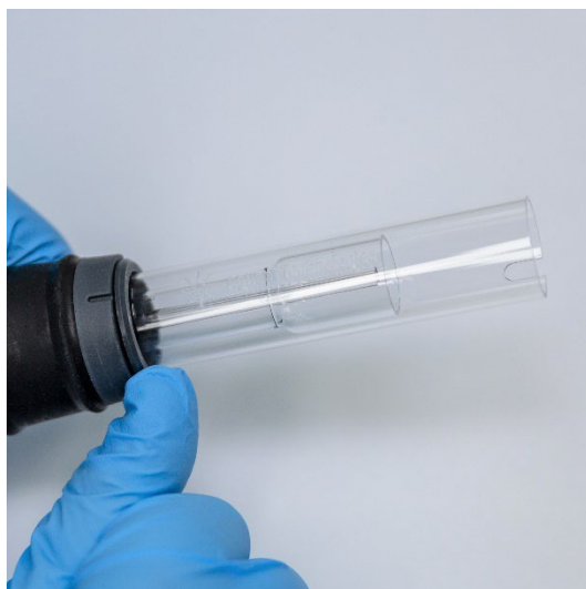
Abbildung 9. Entfernen der oberen Dichtung einer teilweise zerlegbaren Fackel mit dem Daumnagel
