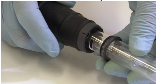
Abbildung 6. Fackel wird in den Fackelkörper eingesetzt
