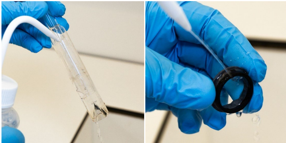
Abbildung 17A und B. Spülen des Quarz-Außenrohrsets und der oberen Dichtung mit deionisiertem Wasser.
