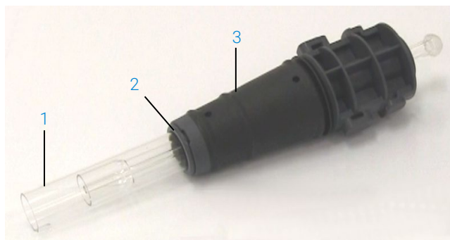
Abbildung 3. Zerlegbare Fackel mit: 1. Fackel, 2. Obere Dichtung und 3. Fackelkörper
