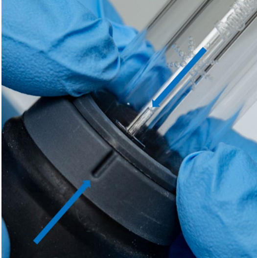
그림 7. 석영 외부 튜브 세트의 정렬 표시가 토치 본체의 홈과 정렬되어야 합니다.
