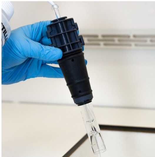
그림 16A. 볼 조인트 커넥터를 통해 탈이온수로 인젝터를 행굼니다.
