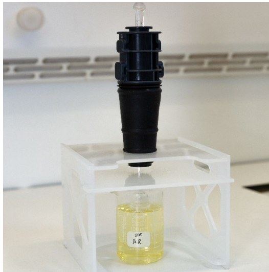
그림 15A. 토치를 왕수 용액에 담급니다. 인젝터가 용액에 담기는지 확인합니다.
