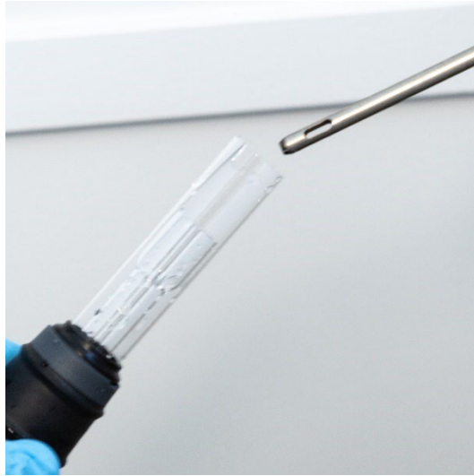
그림 19. 튜브 세트의 개구부를 통해 깨끗한 압축 공기, 아르곤, 질소를 불어 넣습니다.
