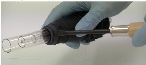
**Imagem 9.** Separação do anel de proteção e do corpo da tocha
