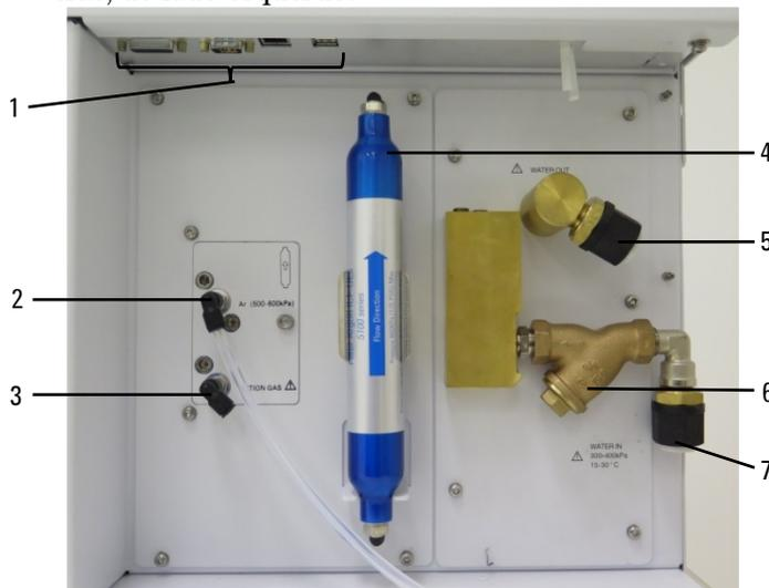
**Imagem 2.** Conexões de entrada e saída na lateral do instrumento ICP-OES
