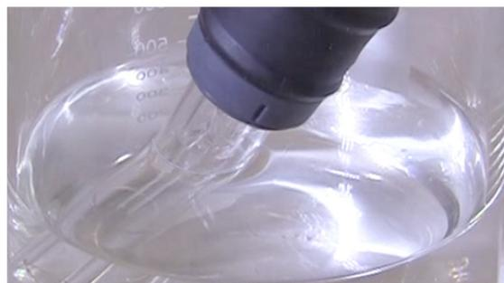
**Imagem 14.** Aproximação da tocha colocada no recipiente, destacando o nível de ácido em relação à base de plástico
