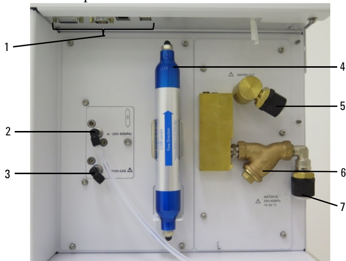
Figura 2. Conexiones de entrada y de salida del lateral del instrumento ICP-OES
