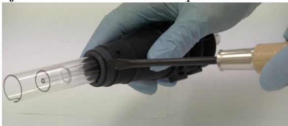
Imagen 9. Separación del anillo de fijación de la antorcha del cuerpo de la antorcha
