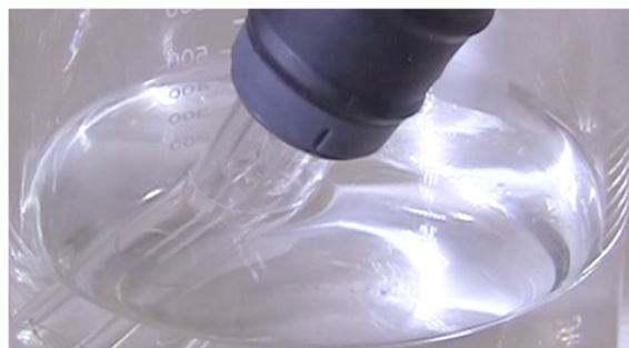
Imagen 14. Primer plano de la antorcha colocada en el recipiente, donde se destaca el nivel de ácido en relación con la base de plástico
