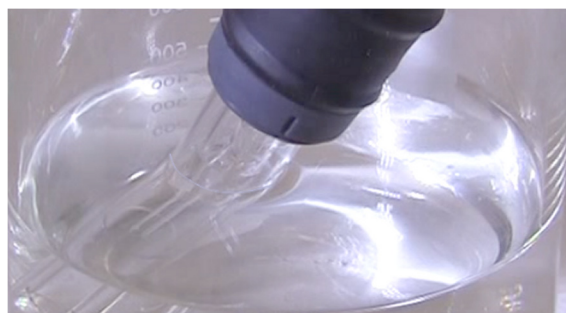
Abb 14. Nahaufnahme der in ein Becherglas gesteckten Fackel, wobei der Füllstand der Säure und deren Abstand zum Kunststoffsockel deutlich zu erkennen sind.
