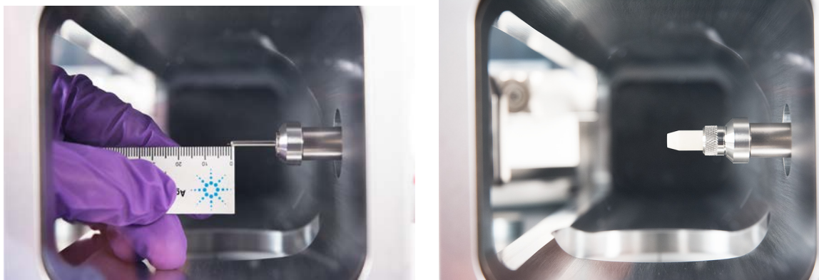
Figura 5 Instalação de uma coluna capilar na interface de GC/MS em uma fonte de EI EXT, SS ou fonte inerte.
