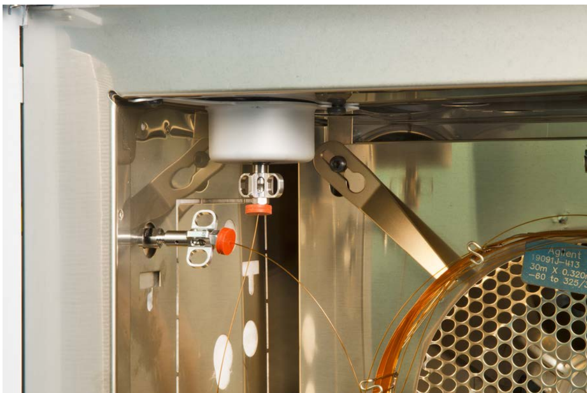
Figura 7 Instalar uma coluna capilar na interface GC/MS
