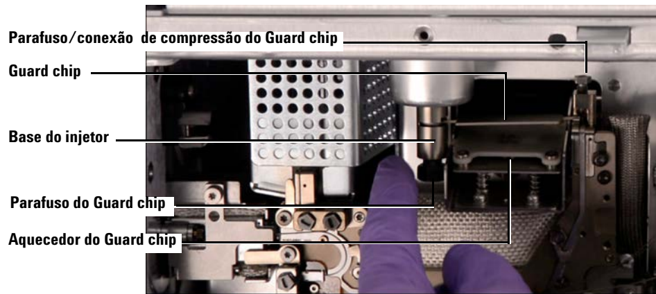
Figura 14 Guard chip e as respectivas peças
