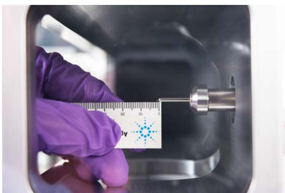
图 5 将毛细管柱安装在 EI EXT、SS 或惰性离子源的 GC/MS 接口中。
