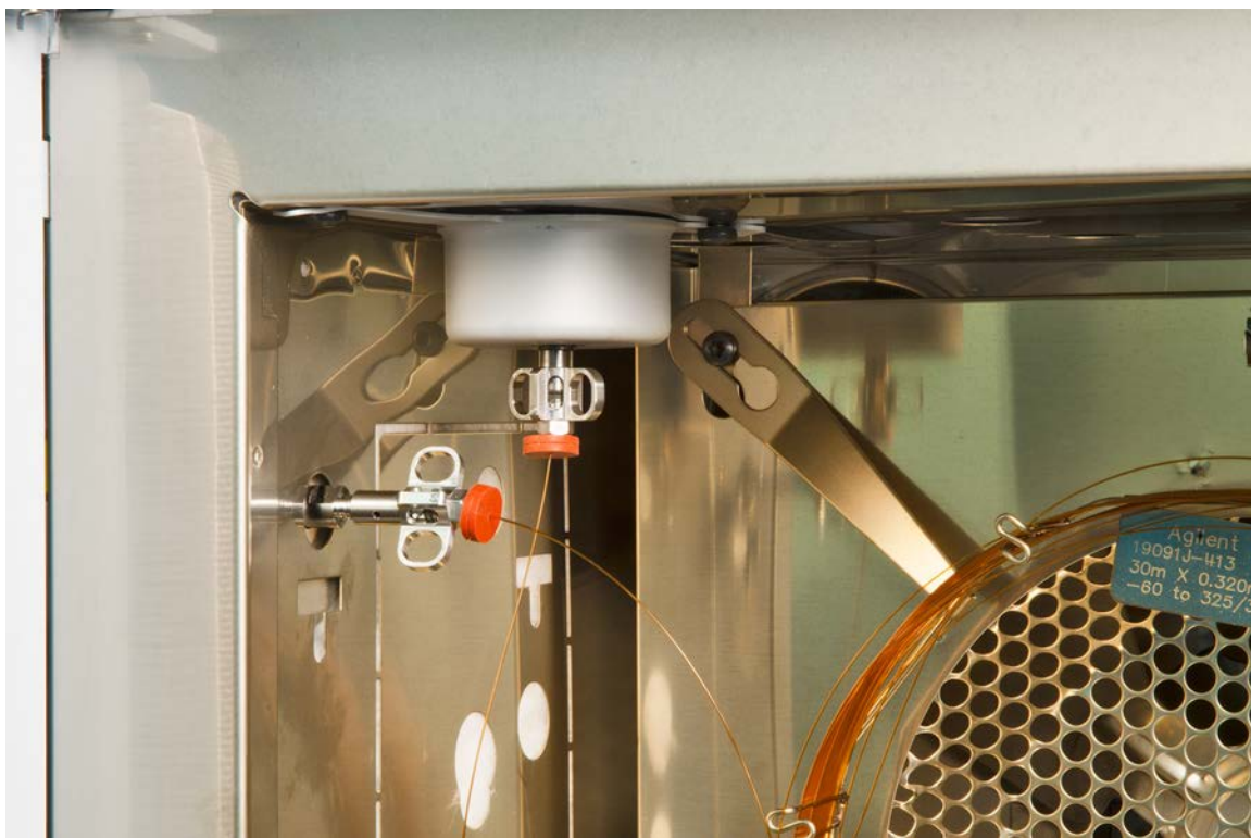
图7 将毛细管柱安装在 GC/MS 接口中
