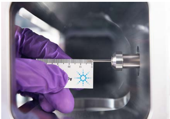
图 6 将毛细管柱安装在 EI HES 离子源的 GC/MS 接口中。
