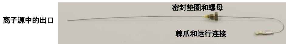
图 17 从 GC/MS 接口取下 9000 GC/MS 尾部
