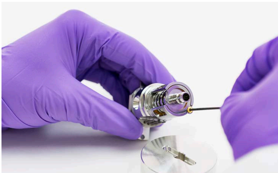
図 40 レンズのネジとインシュレータのロックリングを固定する
