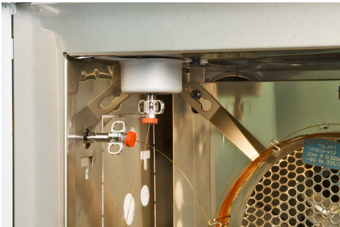
図 7 GC/MS インターフェイスへのキャピラリーカラムの取り付け
