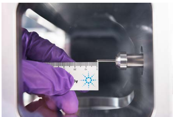
図 5 EI EXT、SS、不活性イオン源の場合の、GC/MS インターフェイスへのキャピラリカラムの取り付け
