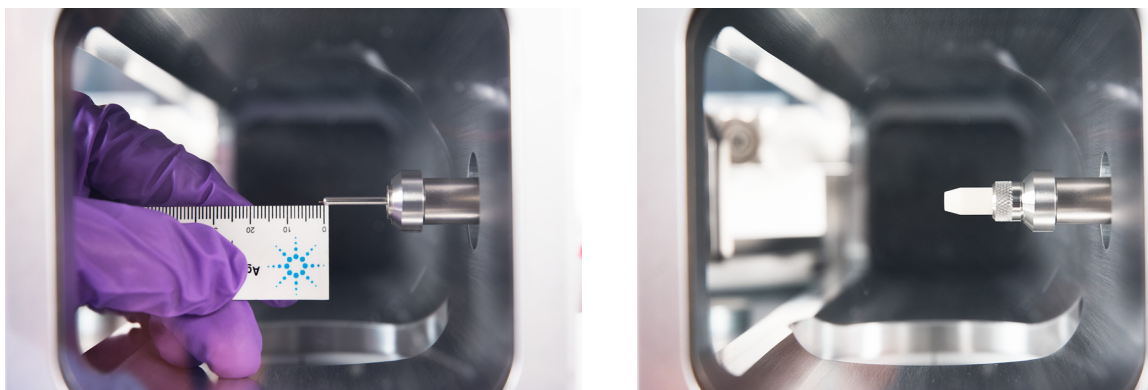
図 5 EI イオン源の場合の、GC/MS インターフェイスへのキャピラリカラムの取り付け
