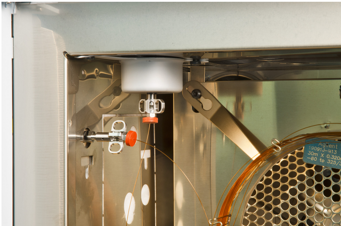
Figure 6 Installation d'une colonne capillaire dans l'interface GC/MS
