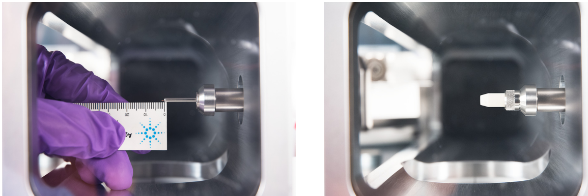
Figure 5 Installation d'une colonne capillaire dans l'interface GC/MS pour une source EI.
