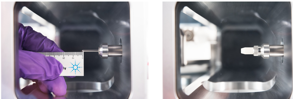
Рисунок 5 Установка капиллярной колонки в интерфейс ГХ-МС для источника ЭУ.
