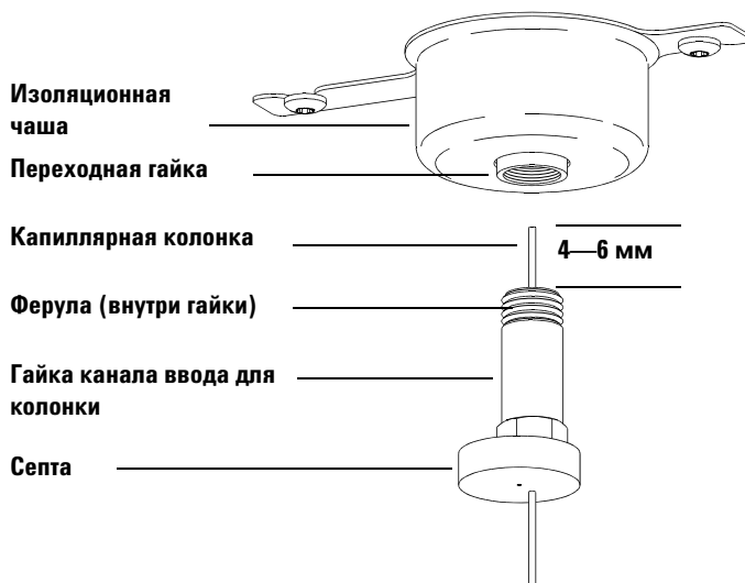
Рисунок 4 Установка капиллярной колонки в разделенный/неразделенный вводной канал
