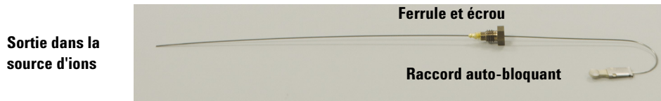
Figure 16 Extrémité du GC/MS 9000 retirée de l'interface GC/MS
