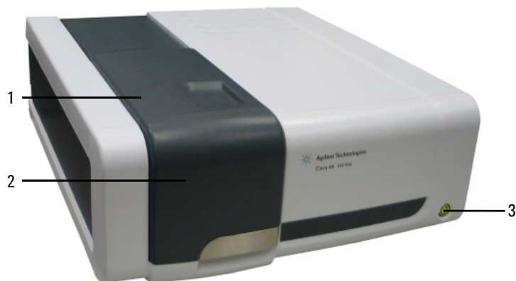
Figura 5. Tampa do compartimento de amostra (1), porta frontal do compartimento de amostra (2) e botão Liga/Desliga (3) do Cary 60.
