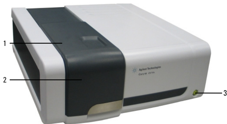
Рис. 5. Показаны крышка кюветного отделения (1), передняя дверца кюветного отделения (2) и кнопка включения (3).
