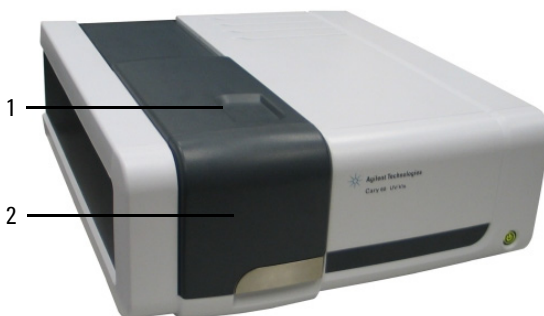
Figura 4. Cary 60 con la tapa del compartimiento de la muestra (1) y la puerta frontal (2)
