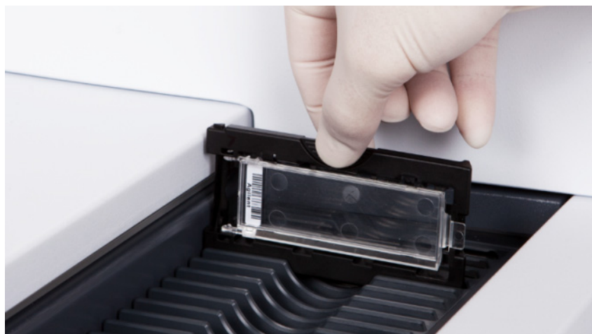
Figure 44 Insertion du porte-diapositive dans le panier
