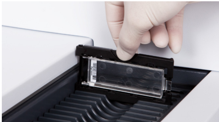
Kuva 44 Diapidikkeen asettaminen kasettiin
