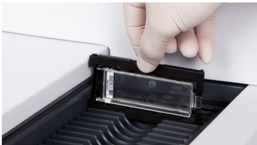
Figura 44 Introducerea suportului pentru lame în casetă
