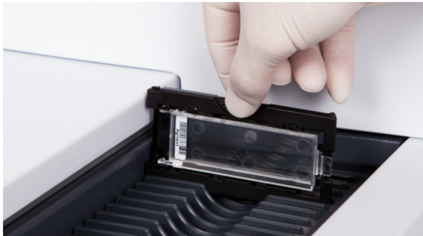
Obrázek 44 Vložení čipu do zásobníku
