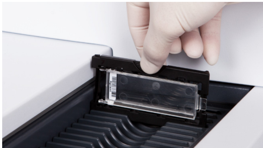
Abbildung 44 Einsetzen des Objektträgerhalters in die Kassette
