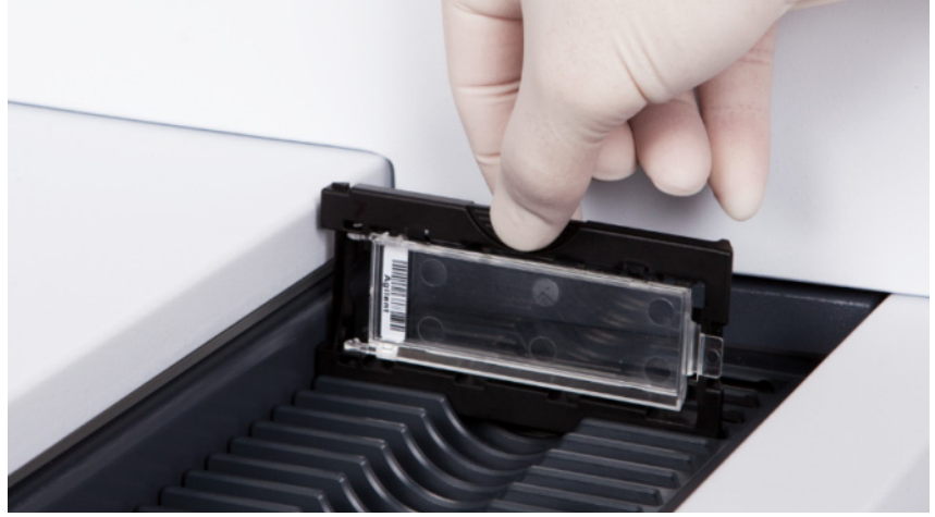
Şekil 44 Slayt tutucunun kasete yerleştirilmesi
