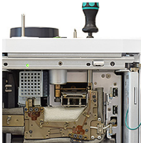
Рис. 3 Раскручивание стягивающего винта защитной пластины (показан канал ввода с/без деления потока)
