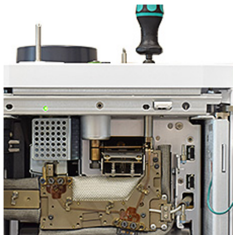
图 3 拧松保护芯片压紧螺钉（所示为分流 / 不分流进样口）
