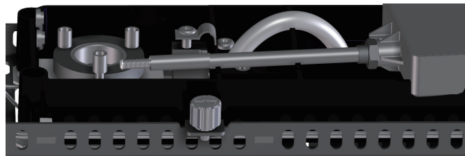
图 10 NPD 收集极、上绝热体和金属 C 形圈
