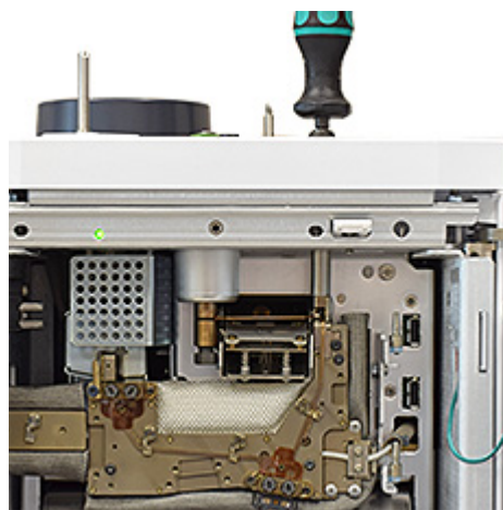
Figura 3 Allentare il bullone di compressione del chip guardia (iniettore split/splitless mostrato)
