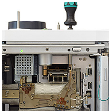
Figure 3 Desserrer le boulon de compression de la plaquette de protection (injecteur avec/sans division indiqué)
