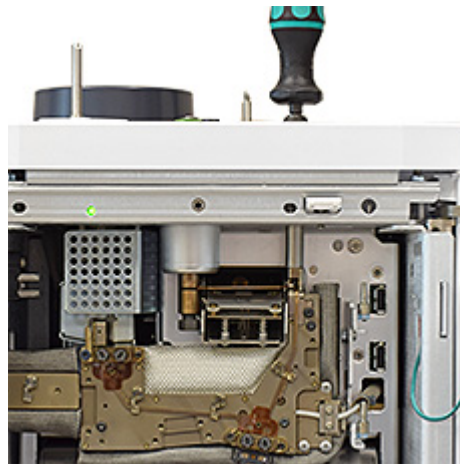
Abb. 3 Lösen des Guard-Chip-Komprimierungsbolzens (Split/Splitless-Einlass abgebildet)
