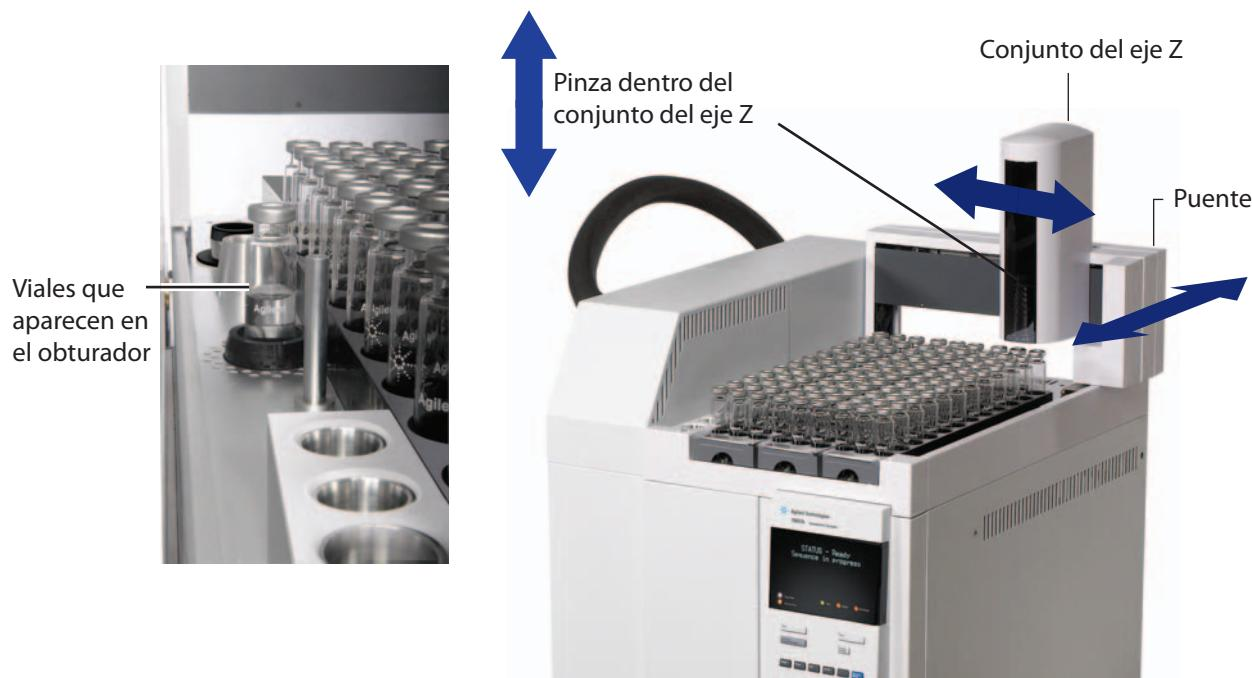
**Figura 12** Partes con movimiento en la bandeja
