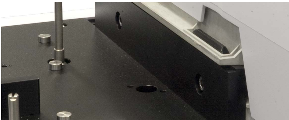
図 65 メインフレーム取り付けブラケットのネジを外す
