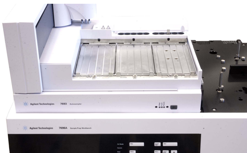
図 94 メインフレーム表面上に均等に配置したパルチェモジュール付きサンプルトレイ
