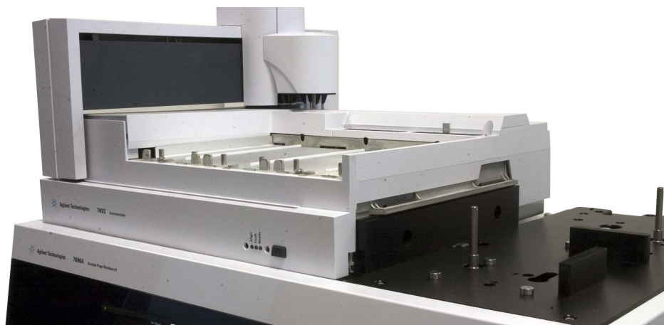
図 43 サンプルトレイをメインフレームベース上に平らに配置する
