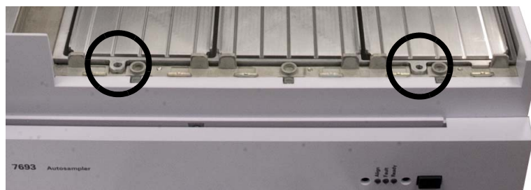
図 87 2 本の T-20 トルクスネジを取り付けて、ペルチェモジュール前面を固定する
