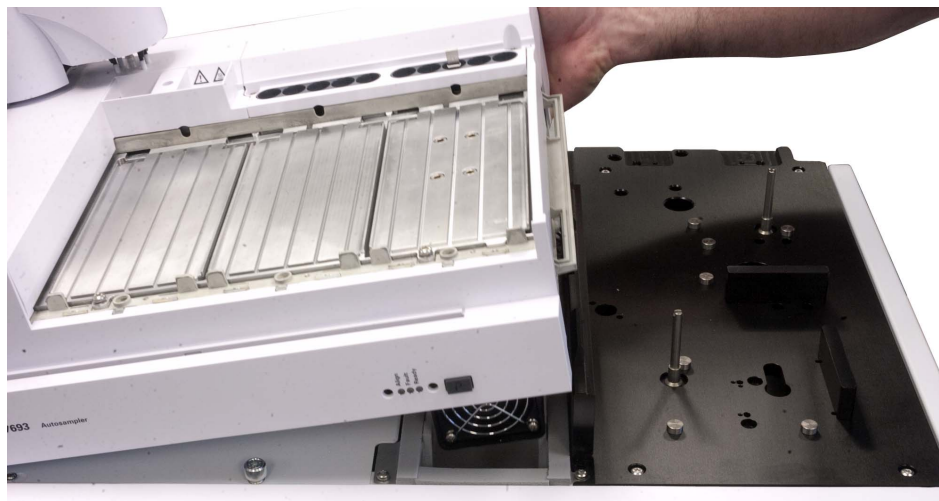
図 93 サンプルトレイをメインフレームシャーシ上に下げる
