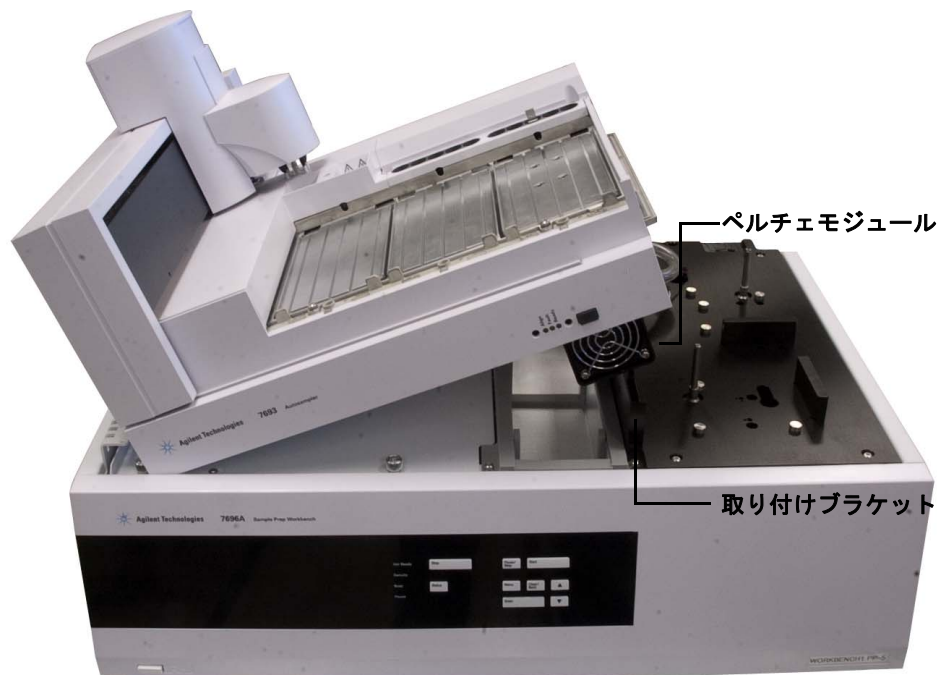
図 91 ペルチェモジュールが取り付けブラケット上に来るように、サンプルトレイをメインフレーム上で支える
