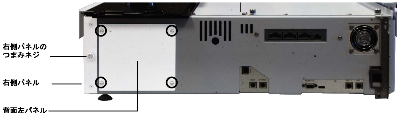
図 33 メインフレームの背面左パネルを取り外す
