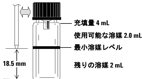
図 127 溶媒を吸引するときのニードル先端の位置
