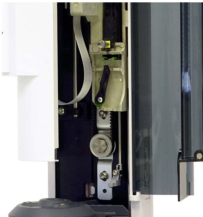
図 17 出荷用クランプが取り外された状態
