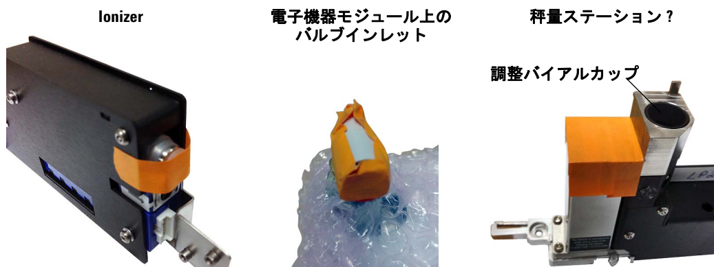
図 30 秤量ステーションコンポーネントからオレンジのテープを外す
