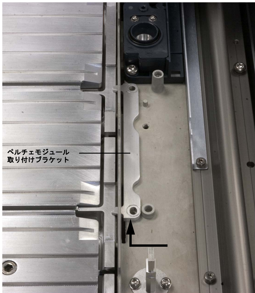
図 88 ペルチェモジュール取り付けブラケットを取り付ける
