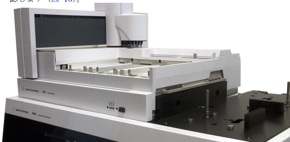
図 13 サンプルトレイをメインフレームベース上に設置する
