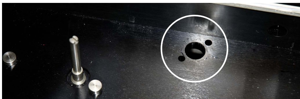
図 51 開口部を秤量モジュールの下面のノブにそろえる
