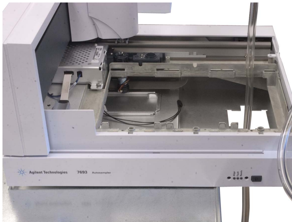
図 83 廃液チューブをアクセサリ開口部に通す
