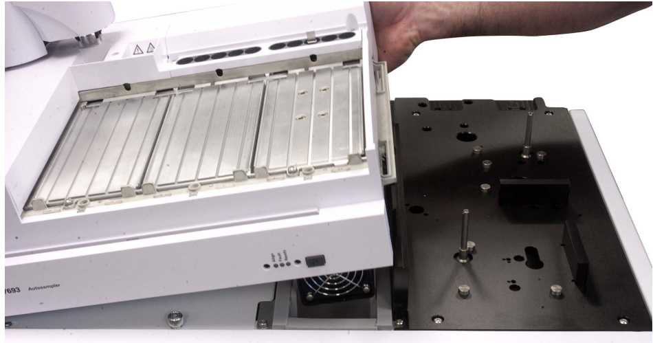
Abb. 93 Senken des Probentellers auf das Grundplattengehäuse
