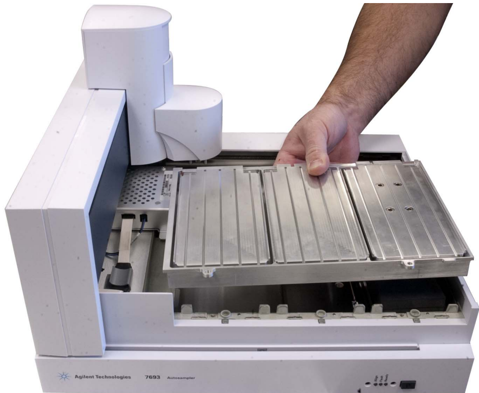
Abb. 85 Installieren des Peltier-Moduls
