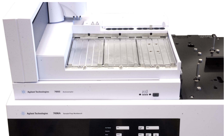
Abb. 94 Probenteller mit Peltier-Modul liegt gerade auf der Grundplattenoberfläche
