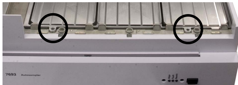
Abb. 87 Anbringen von zwei T-20-Torx-Schrauben zum Sichern der Vorderseite des Peltier-Moduls
