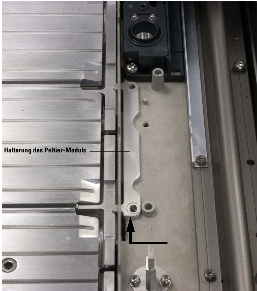
Abb. 88 Installieren der Halterung des Peltier-Moduls
