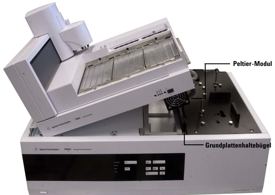
Abb. 91 Absetzen des Probentellers auf der Grundplatte, wobei das Peltier-Modul auf dem Grundplattenhaltebügel ruht
