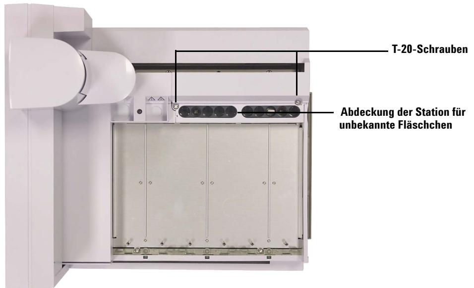
Abb. 78 Entfernen der Schrauben und der Abdeckung der Station für unbekannte Fläschchen
