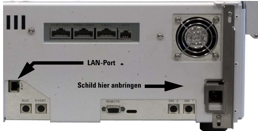
Abb. 4 Spannungsschild und LAN-Port-Positionen
