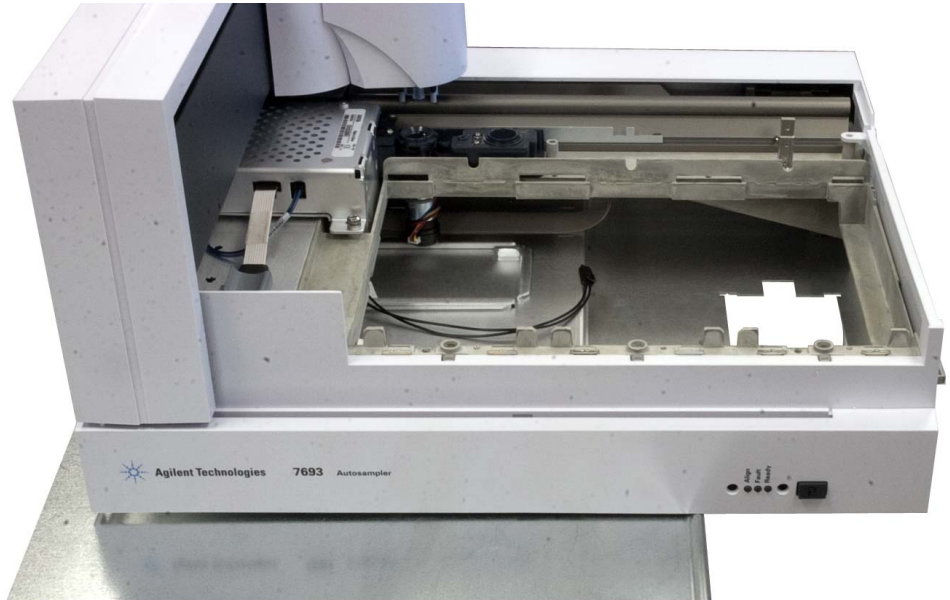
Abb. 77 Absetzen des Probentellers an der Kante eines Arbeits- oder sonstigen Tisches
