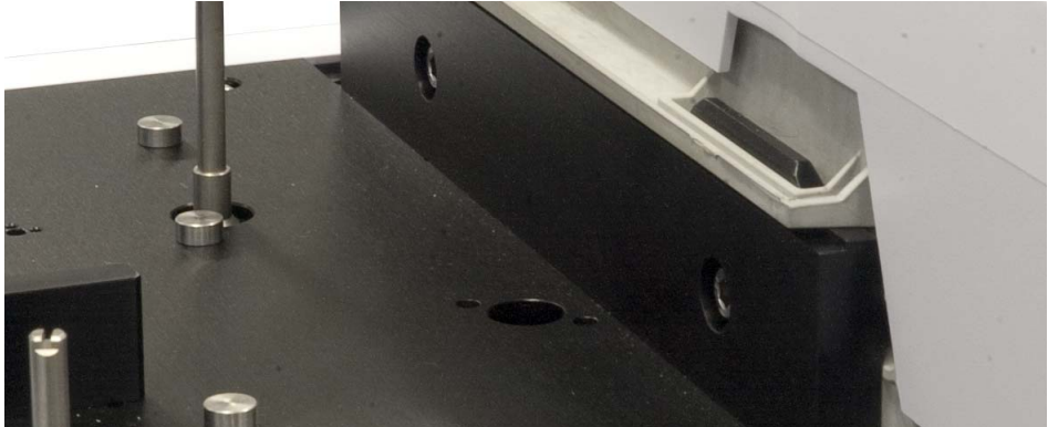
Abb. 65 Entfernen der Schrauben am Grundplattenhaltebügel
