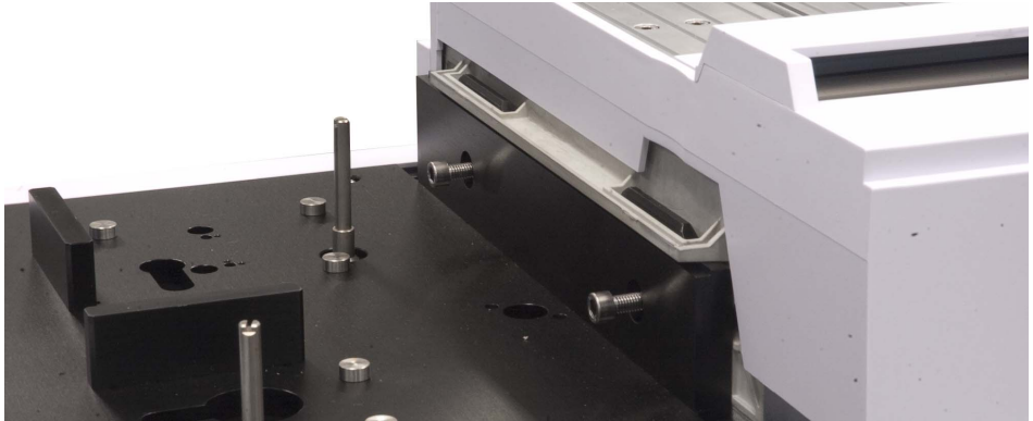
Abb. 96 Sichern des Probentellers am Grundplattenhaltebügel
