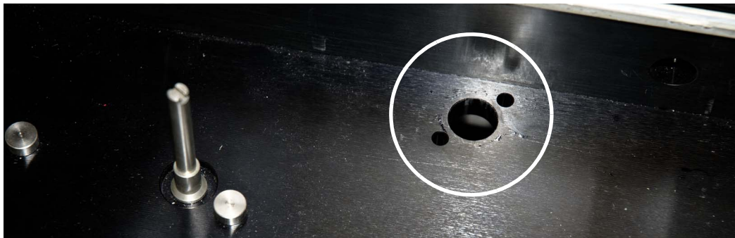
Abb. 51 Richten Sie die Öffnung mit dem Bolzen auf der Unterseite des Wägemoduls passend aus
