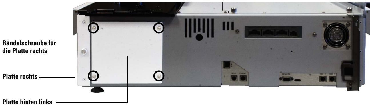
Abb. 33 Entfernen der Platte hinten links von der Grundplatte
