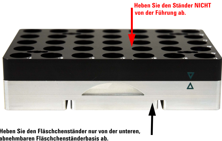
Abb. 107 Heben des abnehmbaren Fläschchenständers mit Führung
