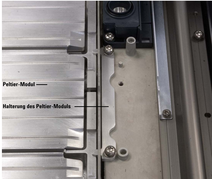
Abb. 89 Sichern von Peltier-Modul und Halterung des Peltier-Moduls
