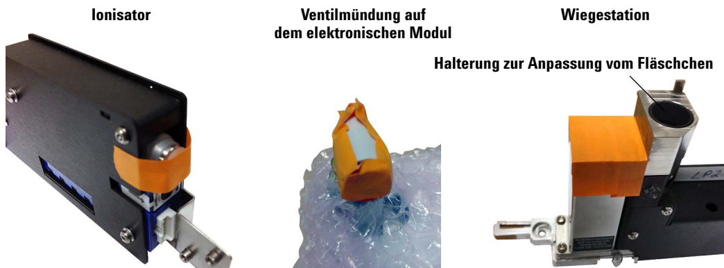
Abb. 30 Entfernen des orangefarbenen Klebebands von den Komponenten der Wiegestation
