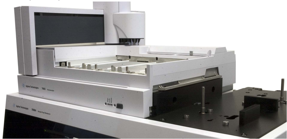
Abb. 13 Flacher Sitz des Probentellers auf der Grundplattenbasis
