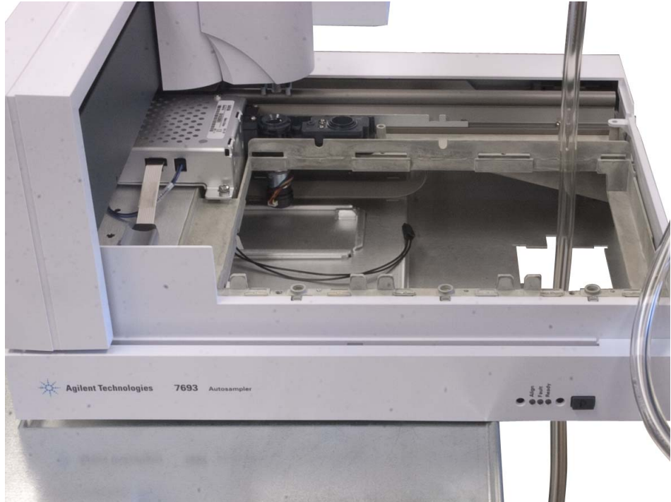
Abb. 83 Führen der Abflussleitung durch die Zubehöröffnung
