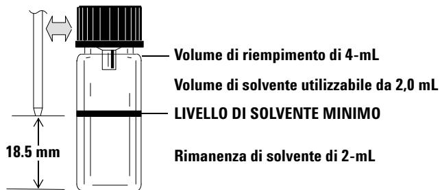
**Figura 51** Posizione della punta dell'ago durante il prelievo di solvente
