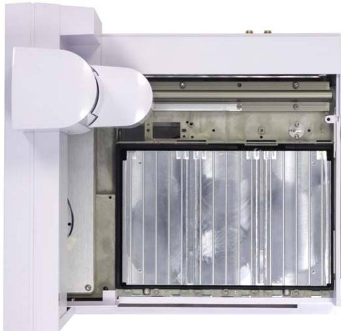
**16** Fissare la piastra di raffreddamento e riscaldamento sul telaio del vassoio tramite quattro viti (due davanti, due dietro).
