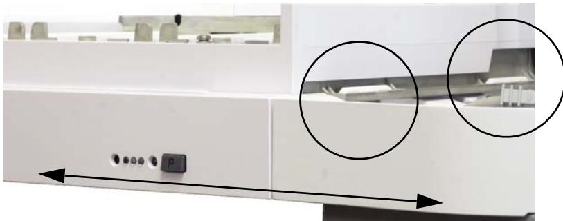
**Figura 5** Vassoio per campioni correttamente installato.
