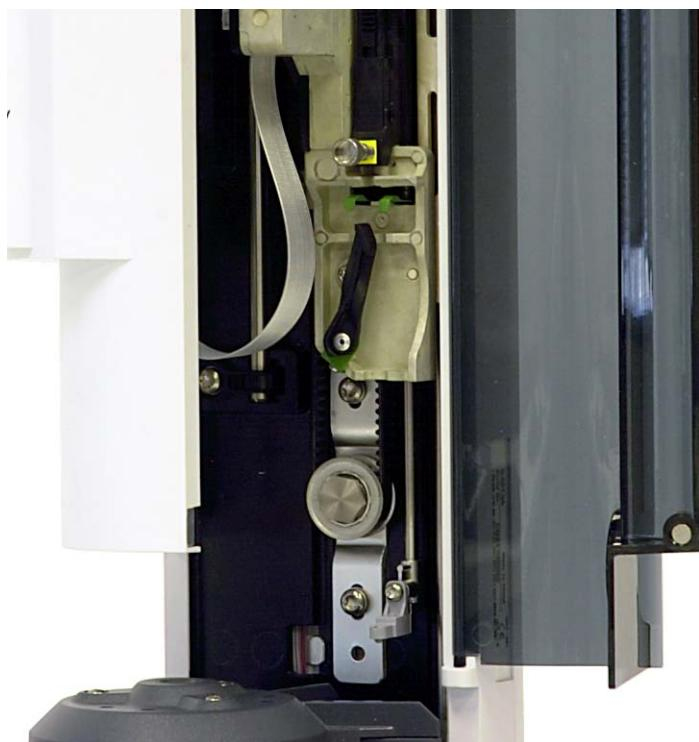
**Figura 9** Morsetto di imballaggio rimosso.
