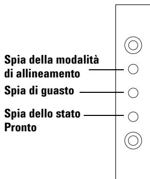
**Figura 77** Spie di stato dell'iniettore G4513A
