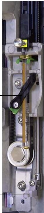
**Figura 64** Circuito di trasporto della siringa e supporto dell'ago con siringa installata
