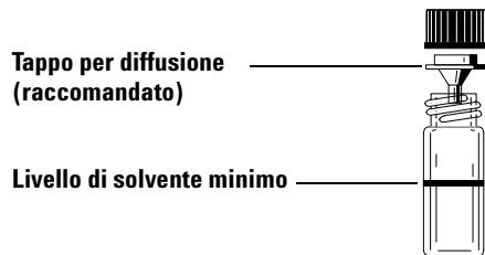
**Figura 50** Bottiglia da quattro millilitri utilizzata per il solvente o lo scarico
