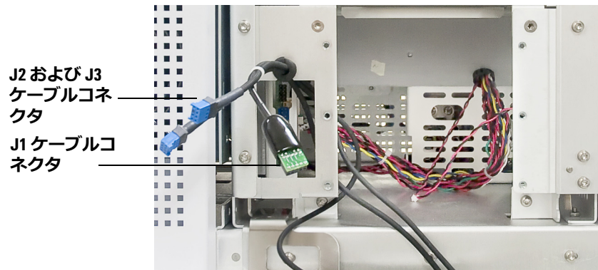
図 14 LTM ケーブル接続
