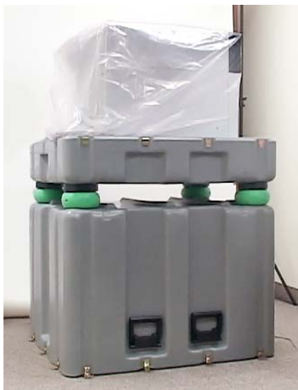
図 12 カバーを使用して、機器を動作する高さまで持ち上げる
