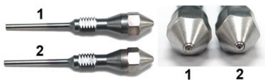
Рис. 2 Оптимизированные сопла для капиллярной колонки
