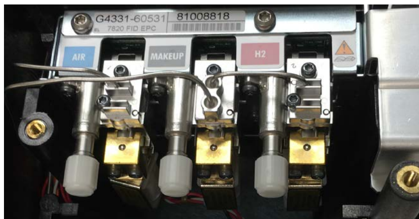
Рис. 2 Пример. Модуль потока ЭКД с подсоединенной трубкой ПИД.
