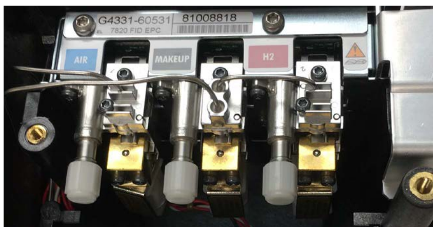
Figura 2 Ejemplo de módulo de flujo EPC con los tubos del FID conectados
