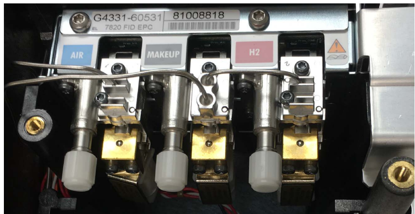
Abbildung 2 Beispiel des EPC-Flussmoduls mit angeschlossener FID-Leitung.
