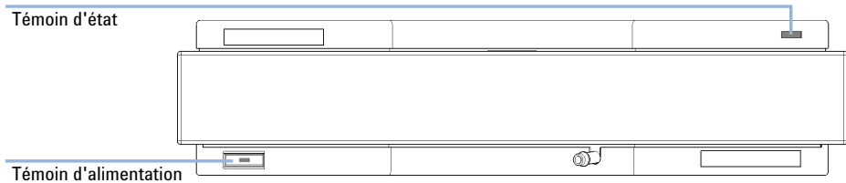
Figure 9 Emplacement des témoins d'état de l'instrument
