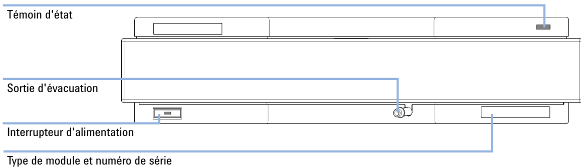
Figure 5 Avant du dégazeur à vide
