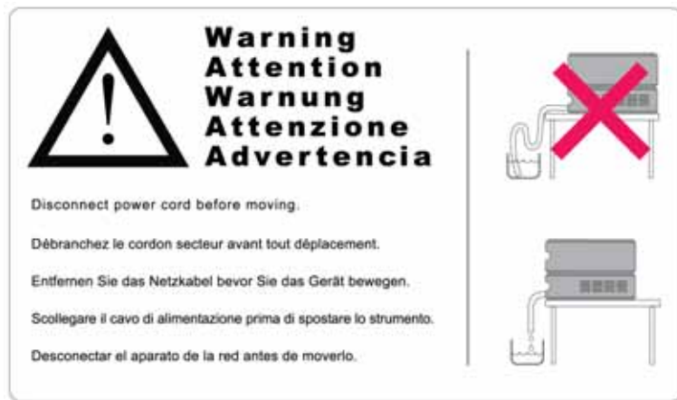
图 8 警告标签（正确的废液管连接的图示）
