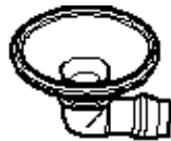
Figura 26 Embudo para fugas
