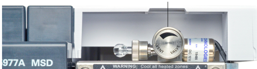
Vanne de mise à l'air
