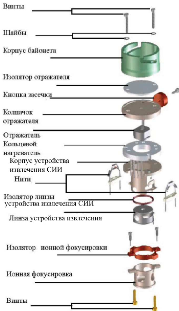
Рисунок 30 Сборка источника ЭУ
