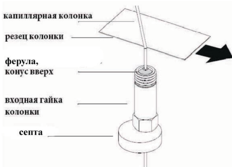
Рисунок 2 Подготовка капиллярной колонки к установке
