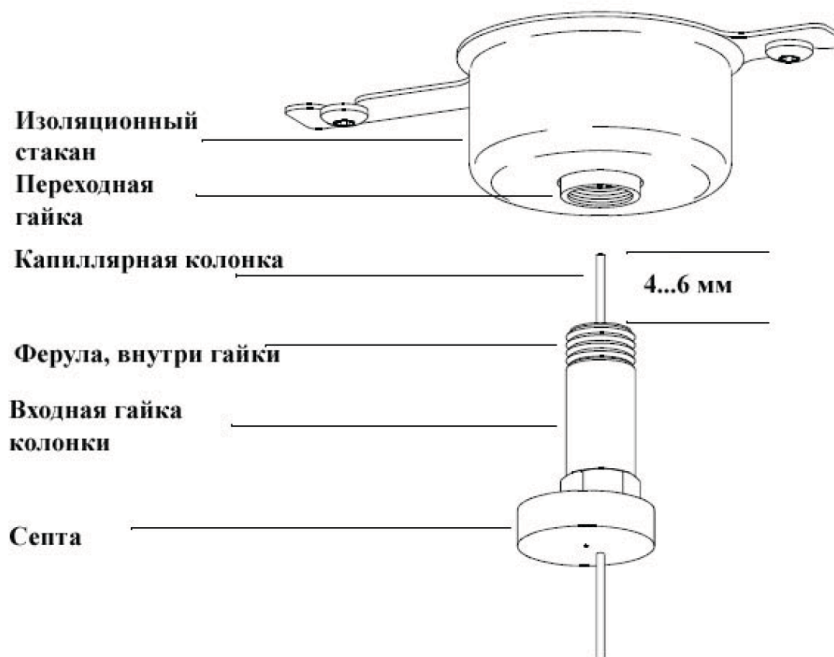
Рисунок 3 Установка капиллярной колонки в инжектор с разделением/без разделения потока
