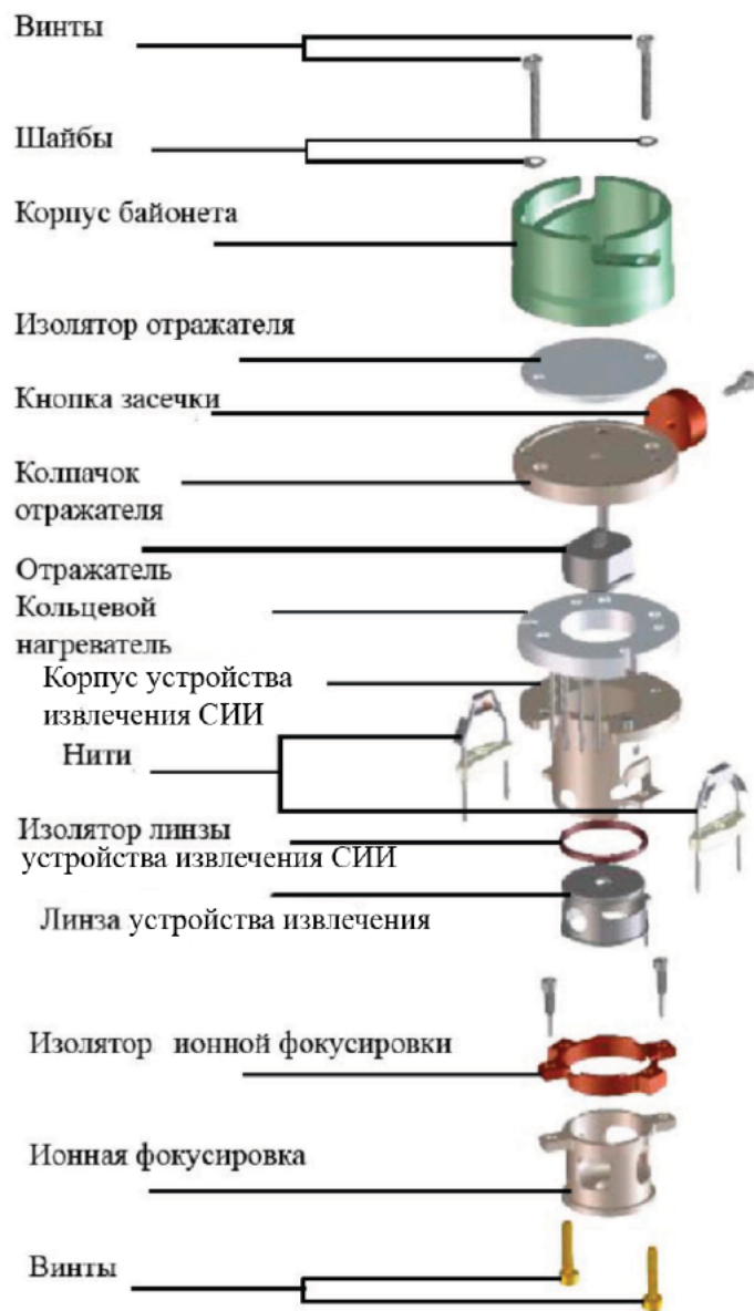
Рисунок 29 Разборка ионного источника ЭУ
