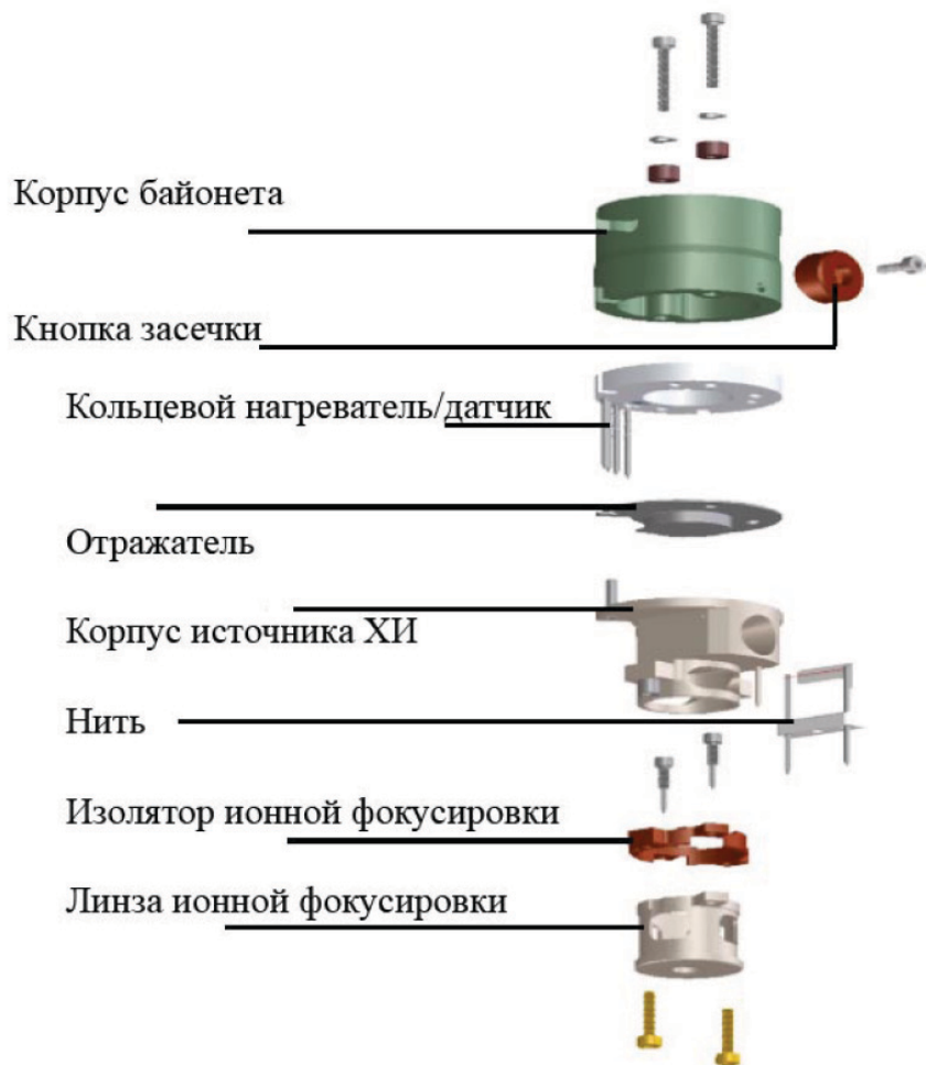
Рисунок 32 Сборка ионного источника ХИ
