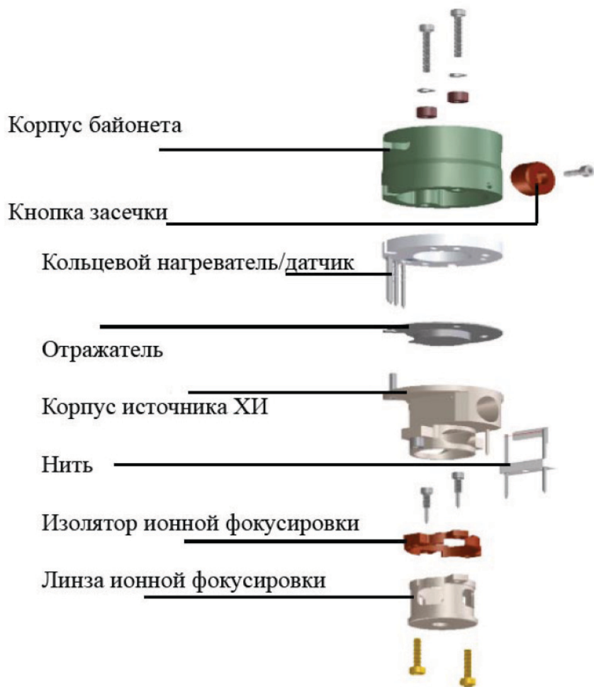
Рисунок 31 Разборка ионного источника ХИ
