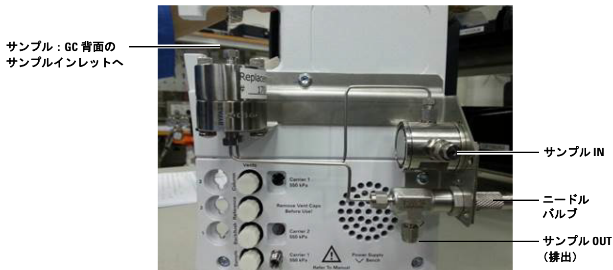
図 22 G3581-S0003 圧力調整器アセンブリを取り付けたところ
