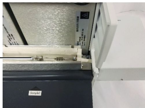
図 17 バックパネルとマイクロガス化装置を取り付け、1/16インチ Swagelok フィッティングを使用して、マイクロガス化装置のサンプルラインを内部サンプルインレットに接続します。
