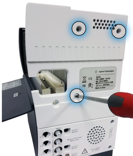
図 15 3本のネジを外して背面パネルを取り外します。
