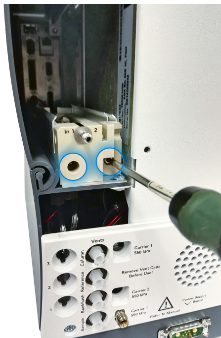
図 16 2本のネジを外して PEEK ブロックを取り外します。
