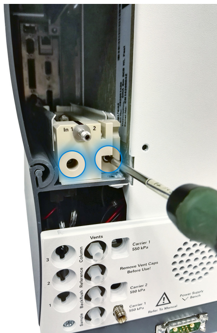
Figura 16 Retire el bloque de PEEK quitando los dos tornillos.
