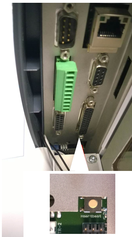
Figura 10 Botón de restablecimiento en la placa principal
