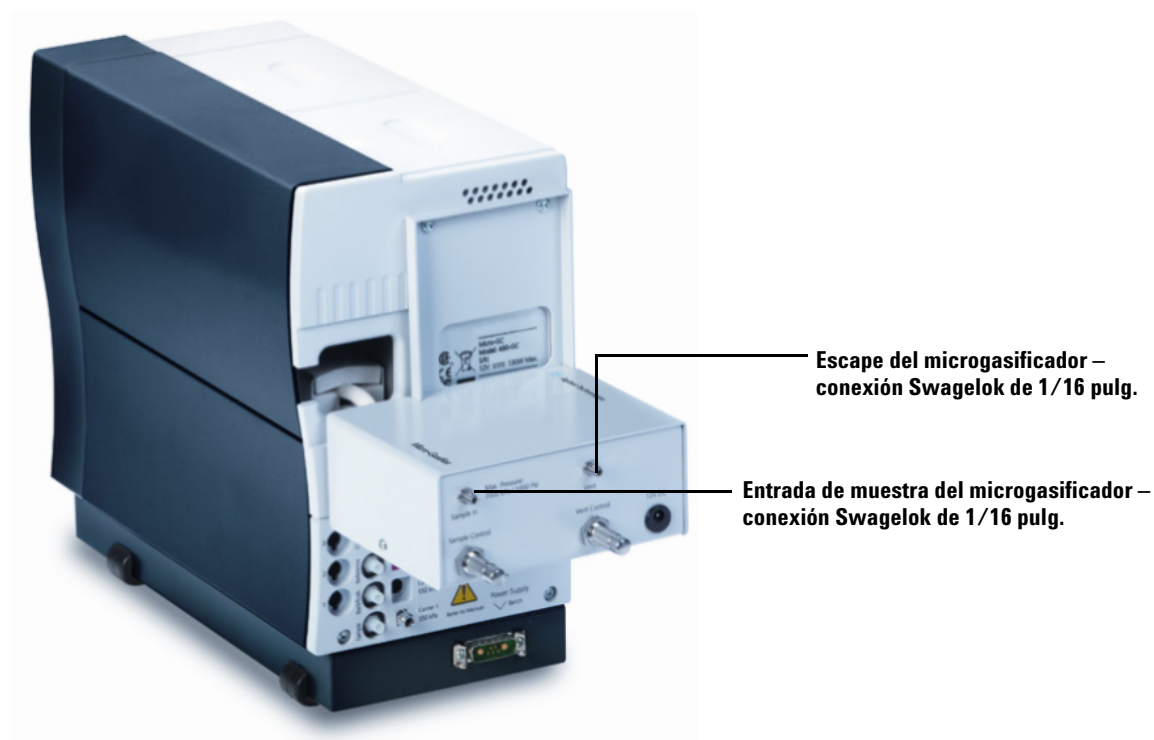
Figura 18 Conexión de línea de muestra y línea de escape del microgasificador.
