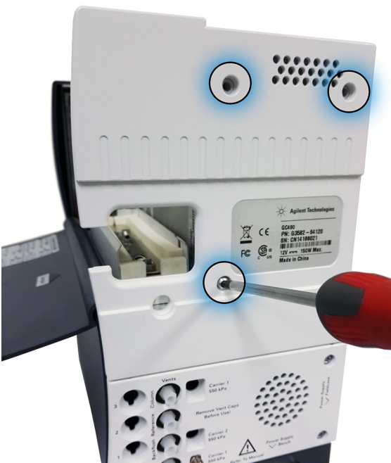
Figura 15 Retire el panel posterior quitando los tres tornillos.
