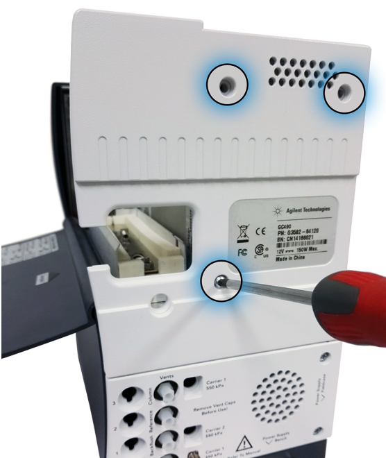
Figure 15 Retirez le panneau arrière en dévissant les trois boulons.
