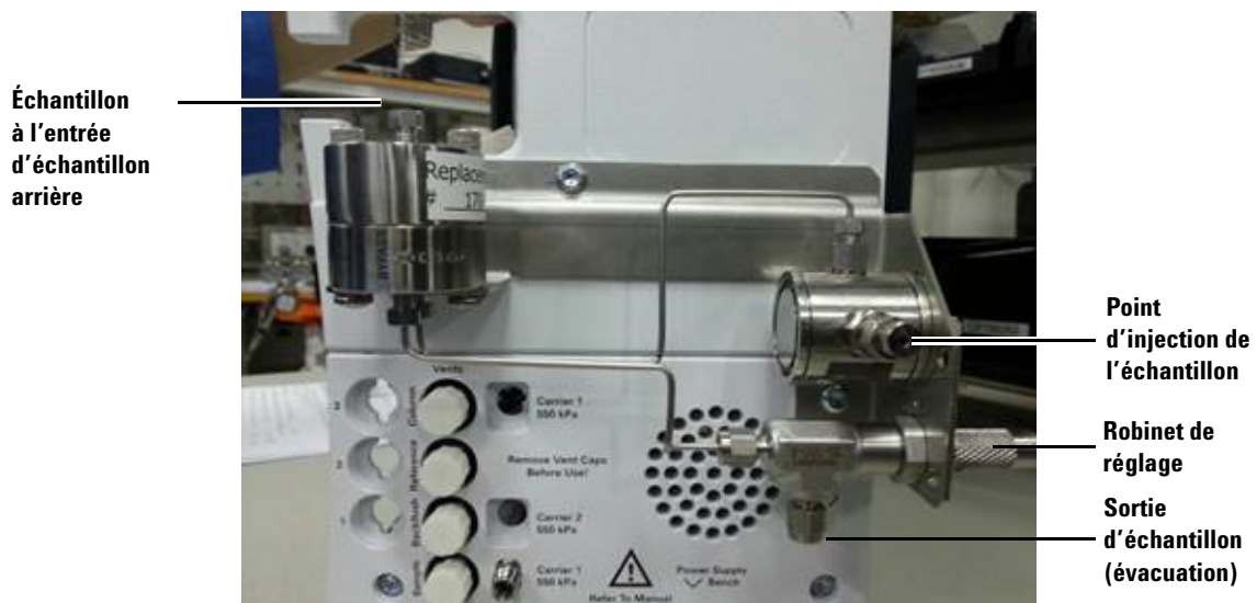
Figure 22 Régulateur de pression G3581-S0003 installé
