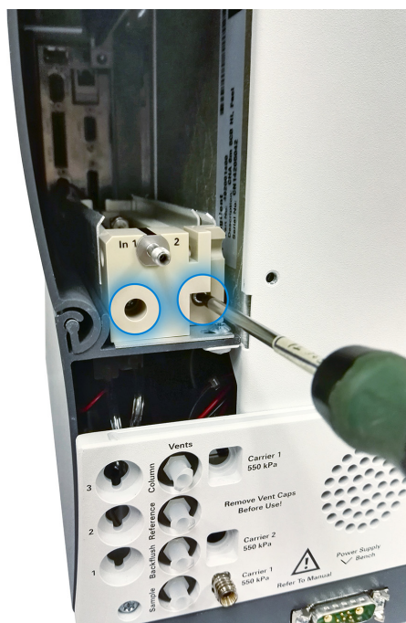
Figure 16 Retirez le bloc PEEK en dévissant les deux boulons.
